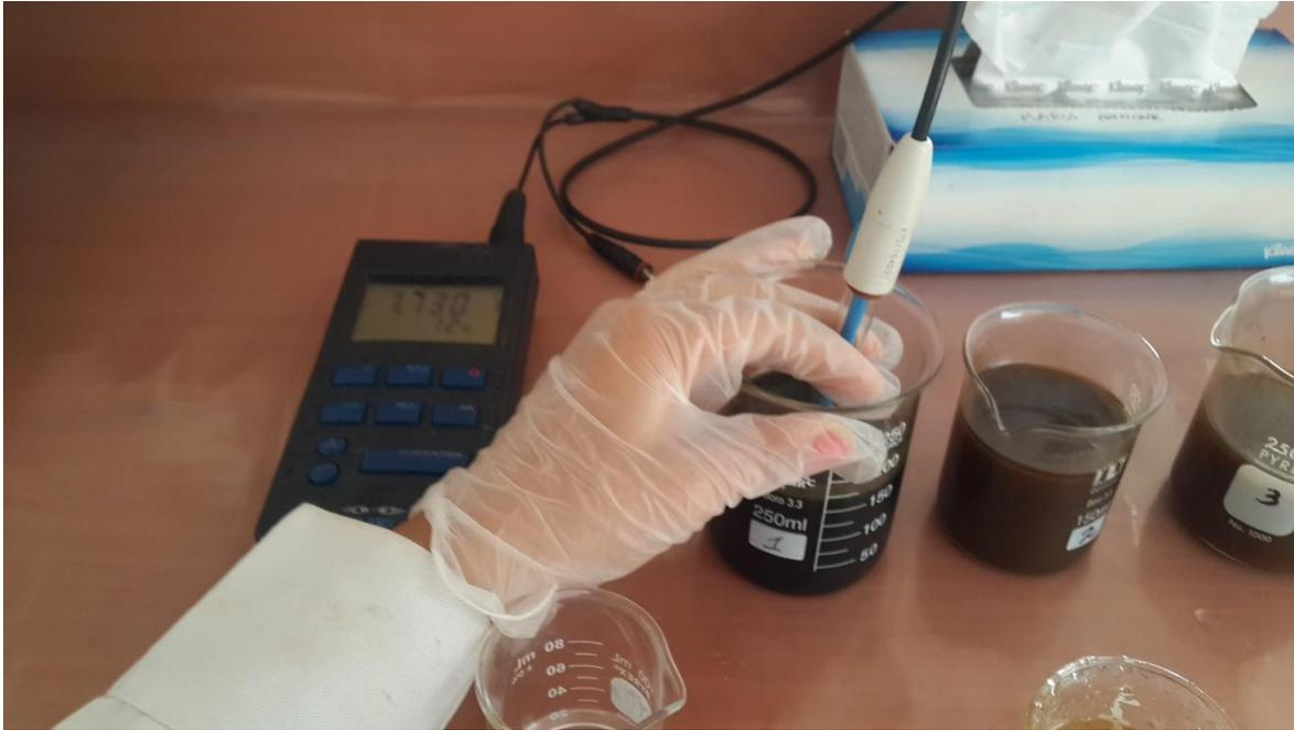
**Foto 10.** Verificación de pH, se ajustó el pH hasta el rango entre 6 y 8.
