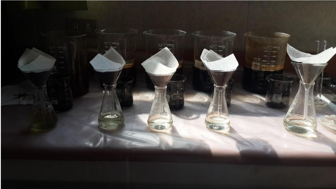
Foto 11. Producto de filtración. Prueba 2 Optimización de Sulfato Ferroso. Producto de filtración.
