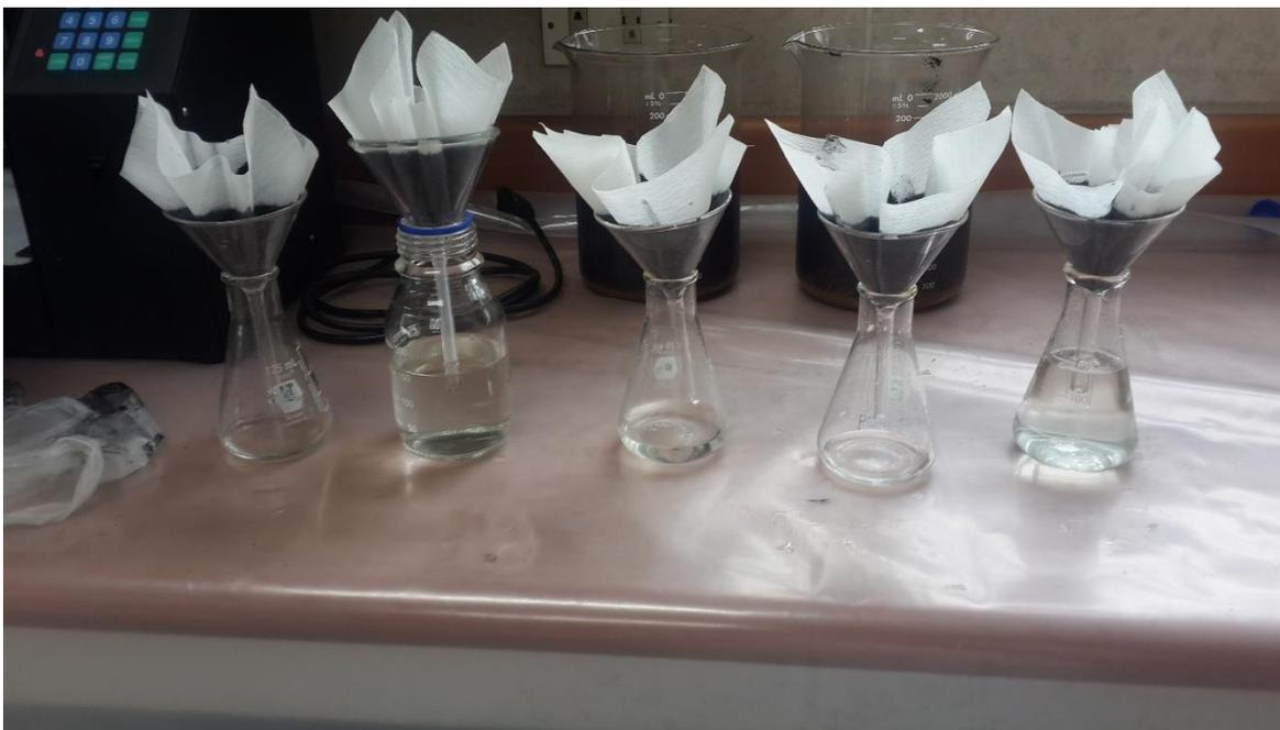
**Foto 13.** Producto de filtración. Prueba 2 Optimización de Sulfato Ferroso. Producto de filtración.
