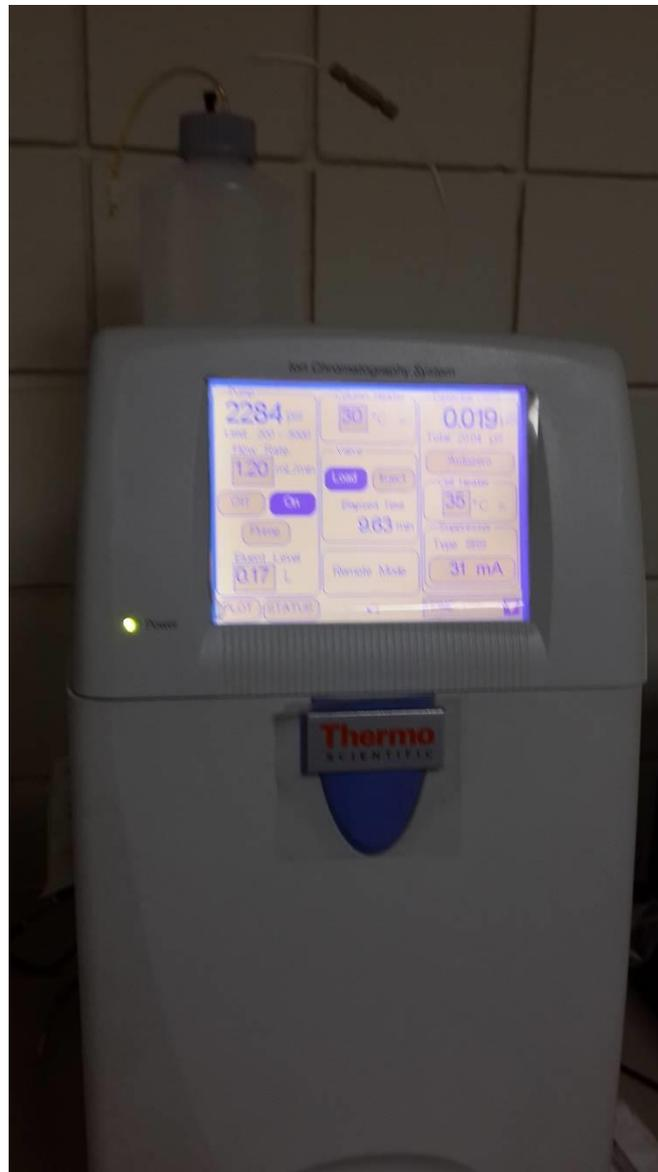
**Foto 17.** Medición de iones disueltos. Equipo de cromatografía iónica.
