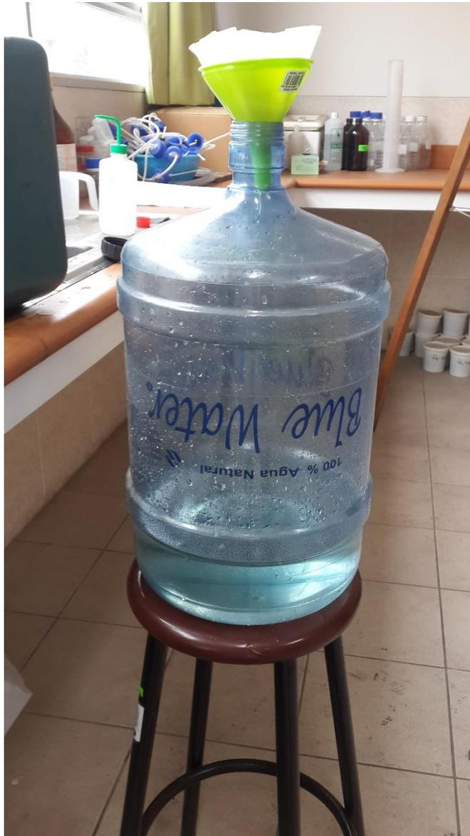
**Foto 19.** Colecta de muestra tratada para realización de análisis de calidad del agua en Certimín.
