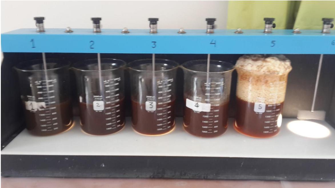
**Foto 5.** Reacción violenta en jarra N° 5, la reacción de oxidación ocurre muy rápido por un exceso de peróxido de hidrógeno, produjo un incremento de temperatura, formación de espuma y burbujeo intenso.
