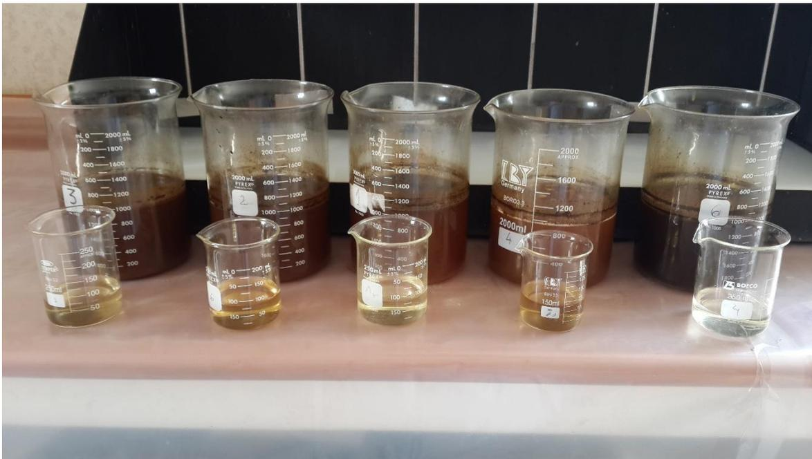
**Foto 12.** Producto de filtración. Prueba 2 Optimización de Sulfato Ferroso, segunda repetición. Producto de filtración.
