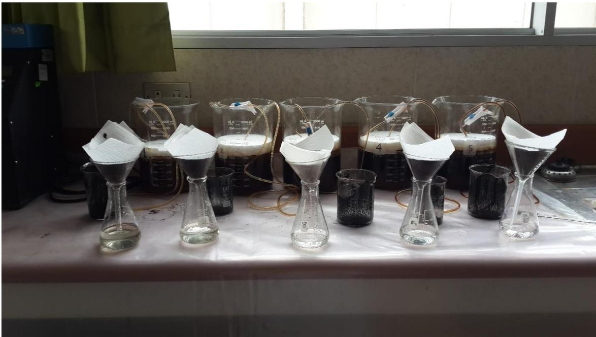
**Foto 10.** Dosificación de carbón activado y filtración de la mezcla. Se utilizó papel de filtración rápida.
