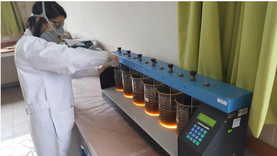
**Foto 4.** Dosificación de peróxido de hidrógeno.
