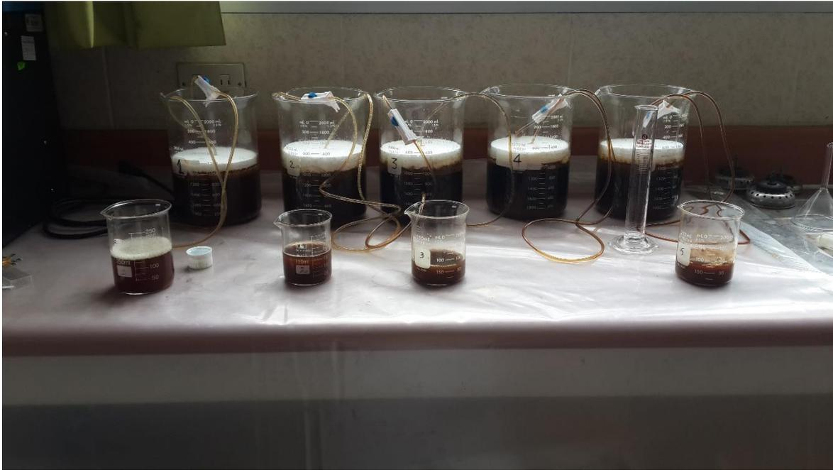
**Foto 8.** Prueba 2 Optimización de Sulfato de Hierro, primera repetición. Toma de muestra para acidificación.
