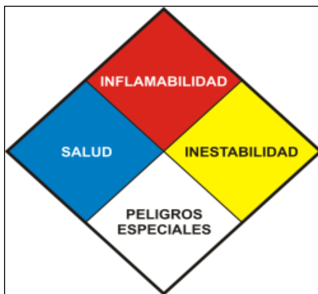
Figura 3: Rombo de Seguridad NFPA 704
