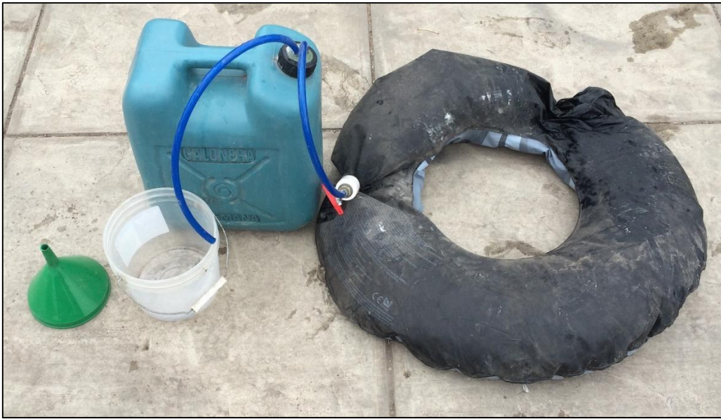
Figura A14: Configuración del equipo para desplazamiento de volúmenes
