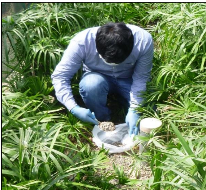
Anexo 1.34: Toma de muestra del filtro (confitillo) para análisis granulométrico por tamizado.
