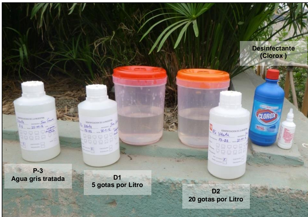
Anexo 1.46: Prueba de cloración en el agua gris tratada (P-3) mediante el uso de desinfectante (Clorox), se aplicaron dos dosis (D1 y D2), y las muestras se enviaron a laboratorio para el análisis de coliformes fecales.
