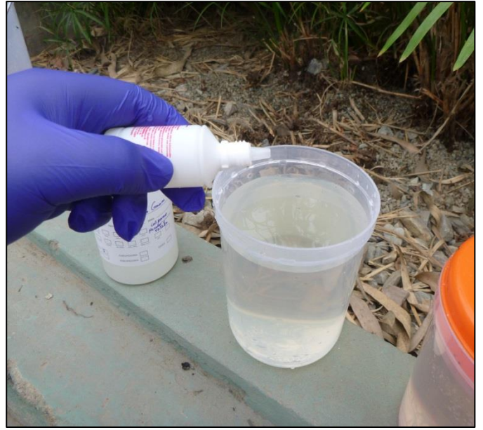
Anexo 1.45: Aplicación de la dosis de cloro en muestra de agua gris tratada (P-3), para prueba de cloración.
