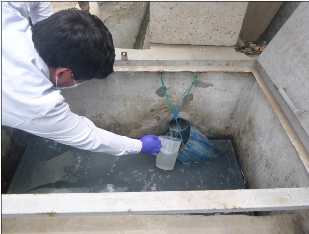
Anexo 1.19: Recolección de muestra puntual para la formación de muestra compuesta en P-1 (agua gris cruda), además de medición del caudal por método volumétrico.
