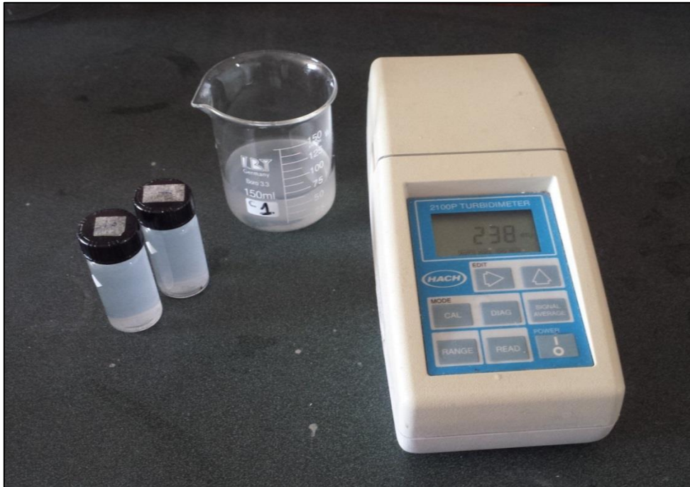
Anexo 1.31: Uso del turbidímetro en laboratorio para la determinación de la turbiedad en las muestras recolectadas.
