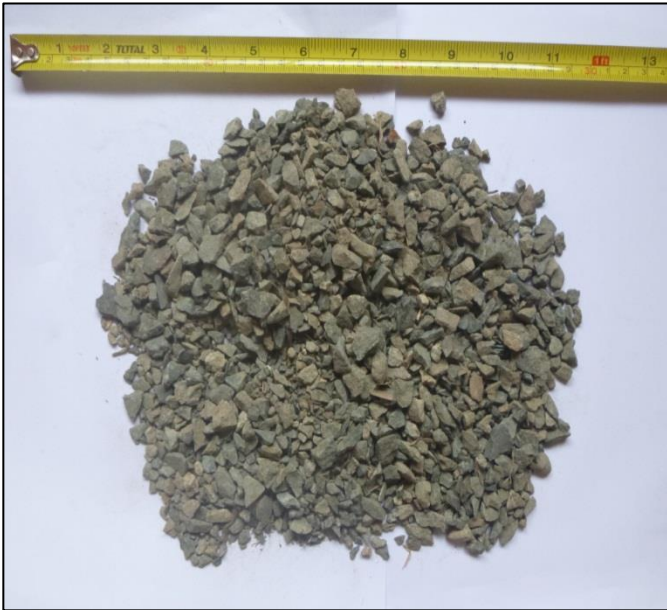
Anexo 1.36: Apariencia del confitillo o grava fina, usado como filtro del humedal.
