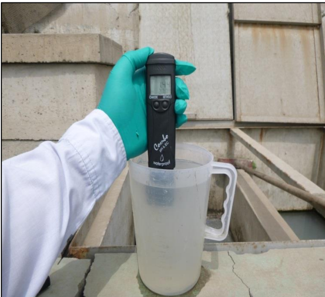
Anexo 1.29: Mediciones con el equipo multiparametro portátil, permite medir Temperatura, pH y Conductividad eléctrica.
