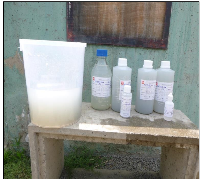
Anexo 1.24: Muestras recolectadas en P-2. Se agregaron preservantes en los parámetros que lo requieren.
