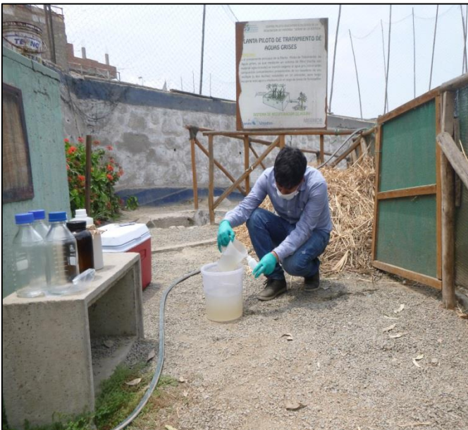
Anexo 1.23: Llenado de frascos de la muestra compuesta en el punto de muestreo P-2.
