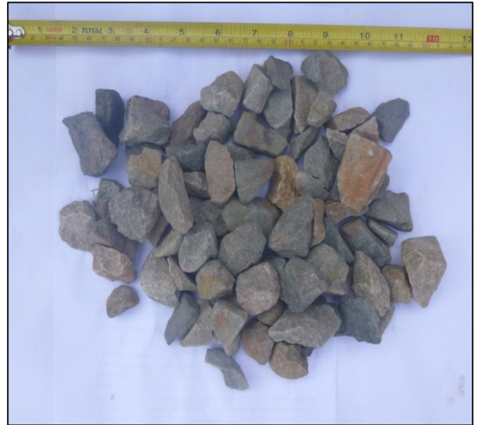
Anexo 1.37: Apariencia de la piedra chancada, usado como material para drenaje en la zona de entrada y salida del humedal.
