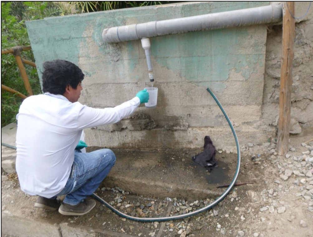
Anexo 1.22: Recolección de muestra puntual para la formación de muestra compuesta en P-2 (agua gris ingreso del humedal o salida de trampa de grasa).
