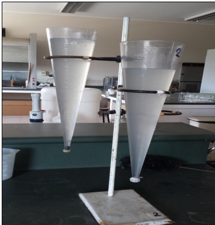
Anexo 1.32: Determinación en laboratorio de los sólidos sedimentables con uso de los conos Imhoff para las muestras recolectadas.
