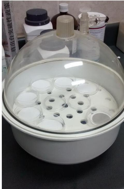
**Fotografía 8:** Placas Petri conteniendo filtros con muestra de PM<sub>2.5</sub>.
