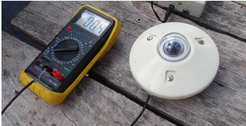
**Foto 9: Instrumento de medición de la Radiación Solar (Solarímetro).**
