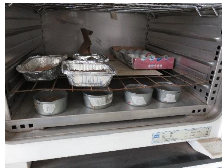
Figura 8: a) Lectura del sensor de humedad. b) Toma de muestra de sustrato. c) Peso húmedo de sustrato. d) Secado en estufa de sustrato
