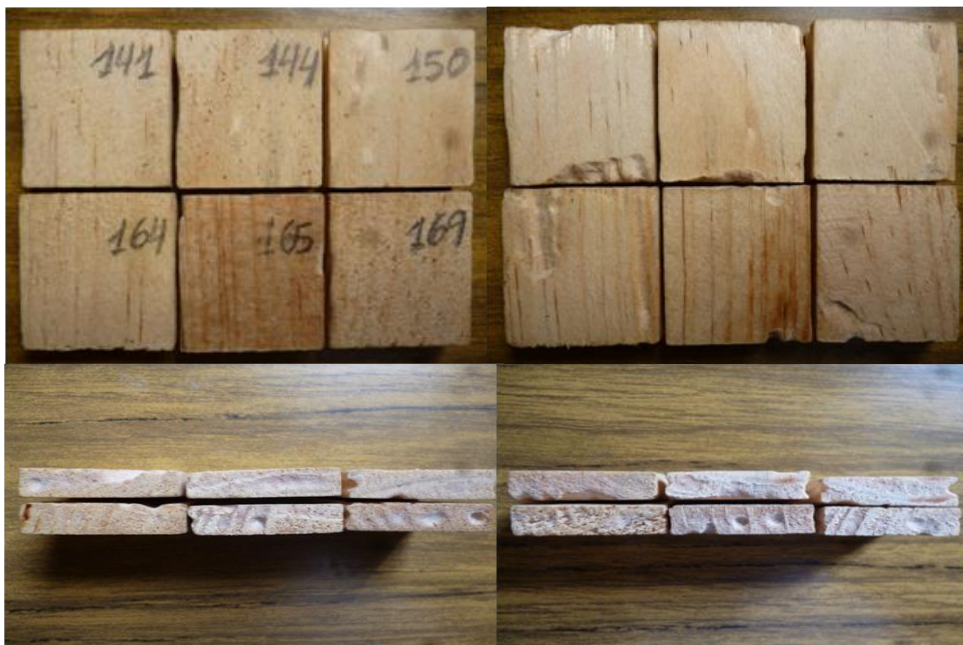
Figura 14: Daño ocasionado en probetas de albura de P. oocarpa con 4 kg/m 3 de retención de la mezcla de Ácido bórico-Bórax.
