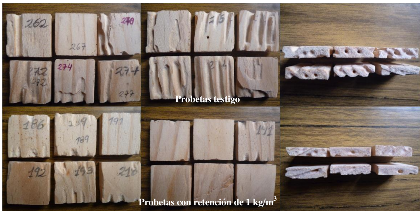
Figura 15: Daño ocasionado en probetas de albura de P. oocarpa sin preservar y con retención de 1 kg/m 3 de Octoborato de sodio.
