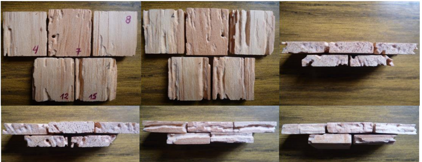
Figura 11: Daño ocasionado en probetas de duramen de P. oocarpa .
