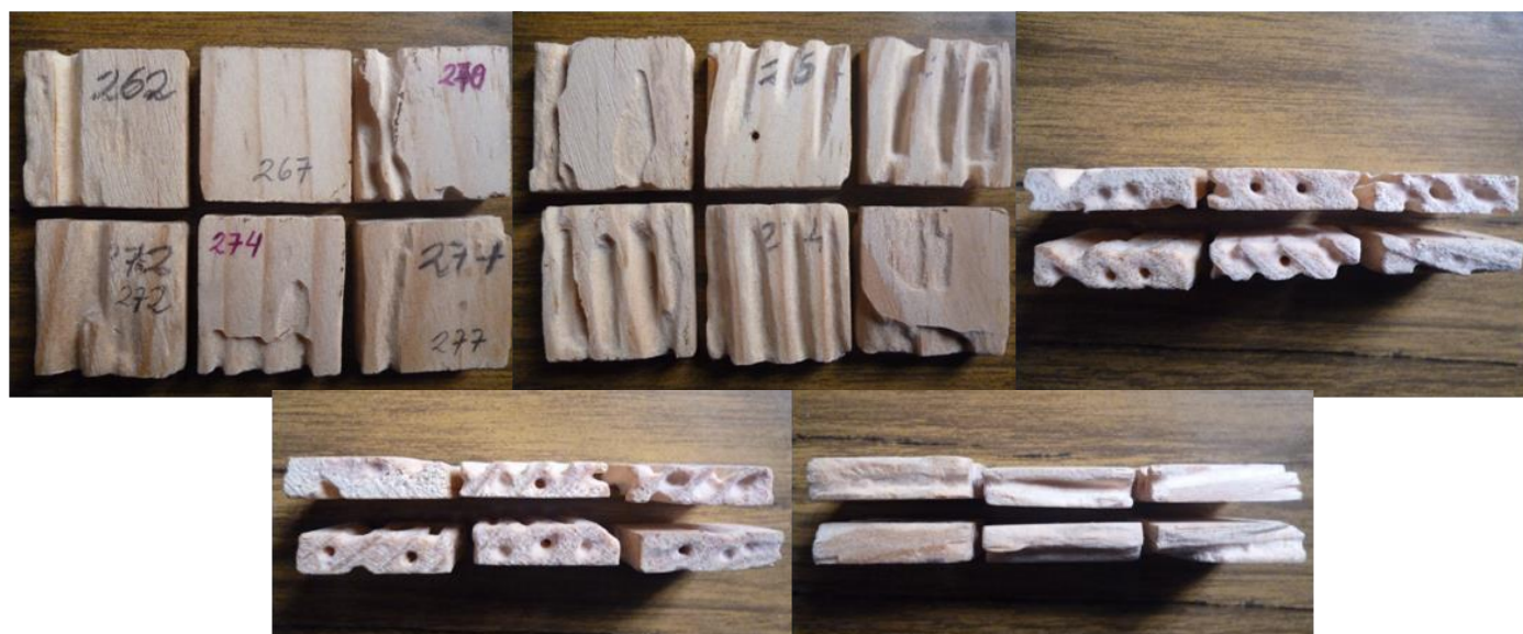
Figura 10: Daño ocasionado en probetas de albura de P. oocarpa .
