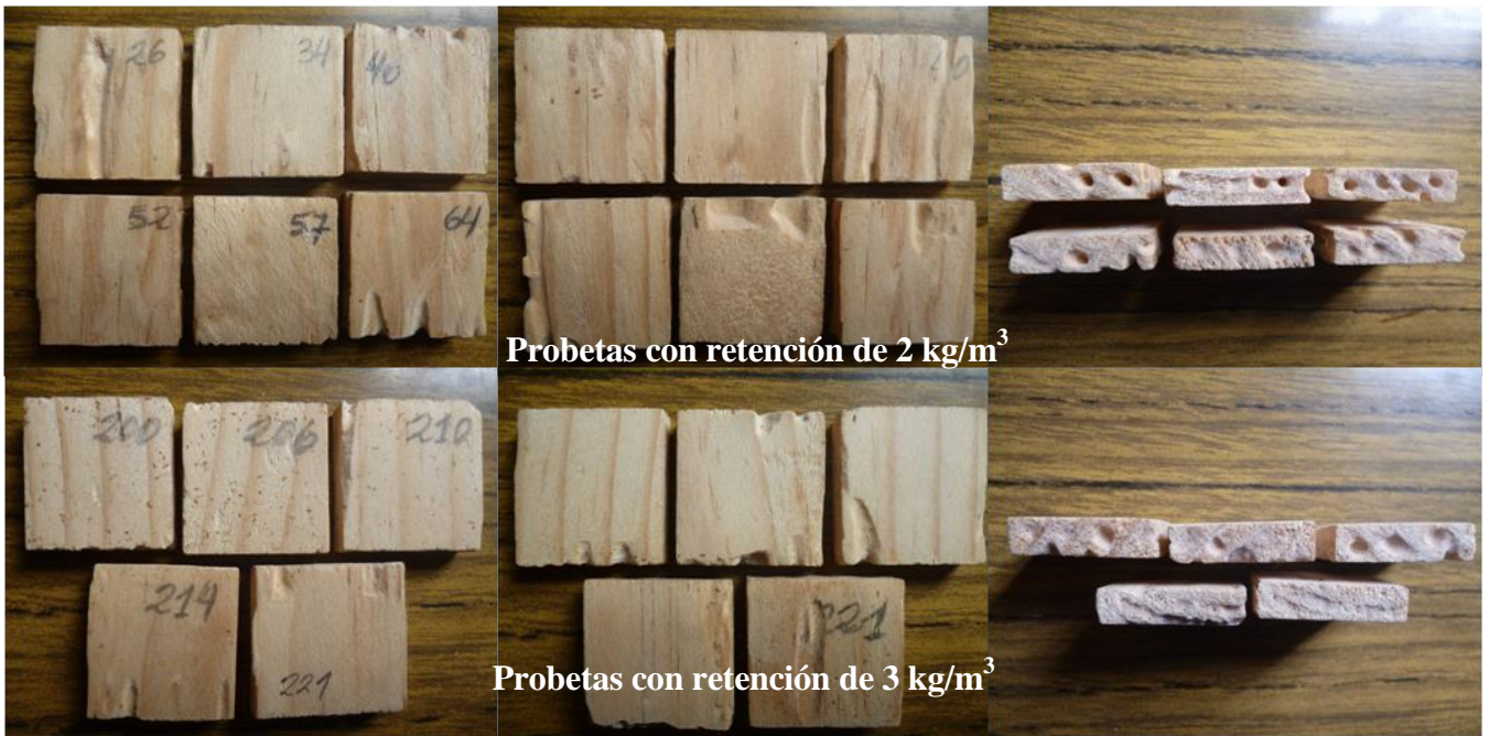
Figura 13: Daño ocasionado en probetas de albura de P. oocarpa con 2 y 3 kg/m 3 de retención de la mezcla de Ácido bórico-Bórax.
