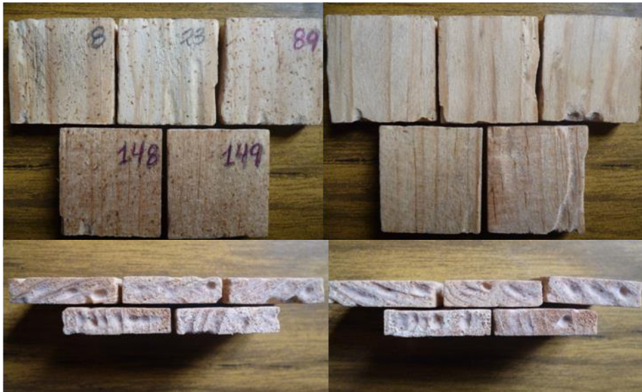
Figura 17: Daño ocasionado en probetas de albura de P. oocarpa con 4 \text{ kg/m}^3 de retención de Octoborato de sodio.
