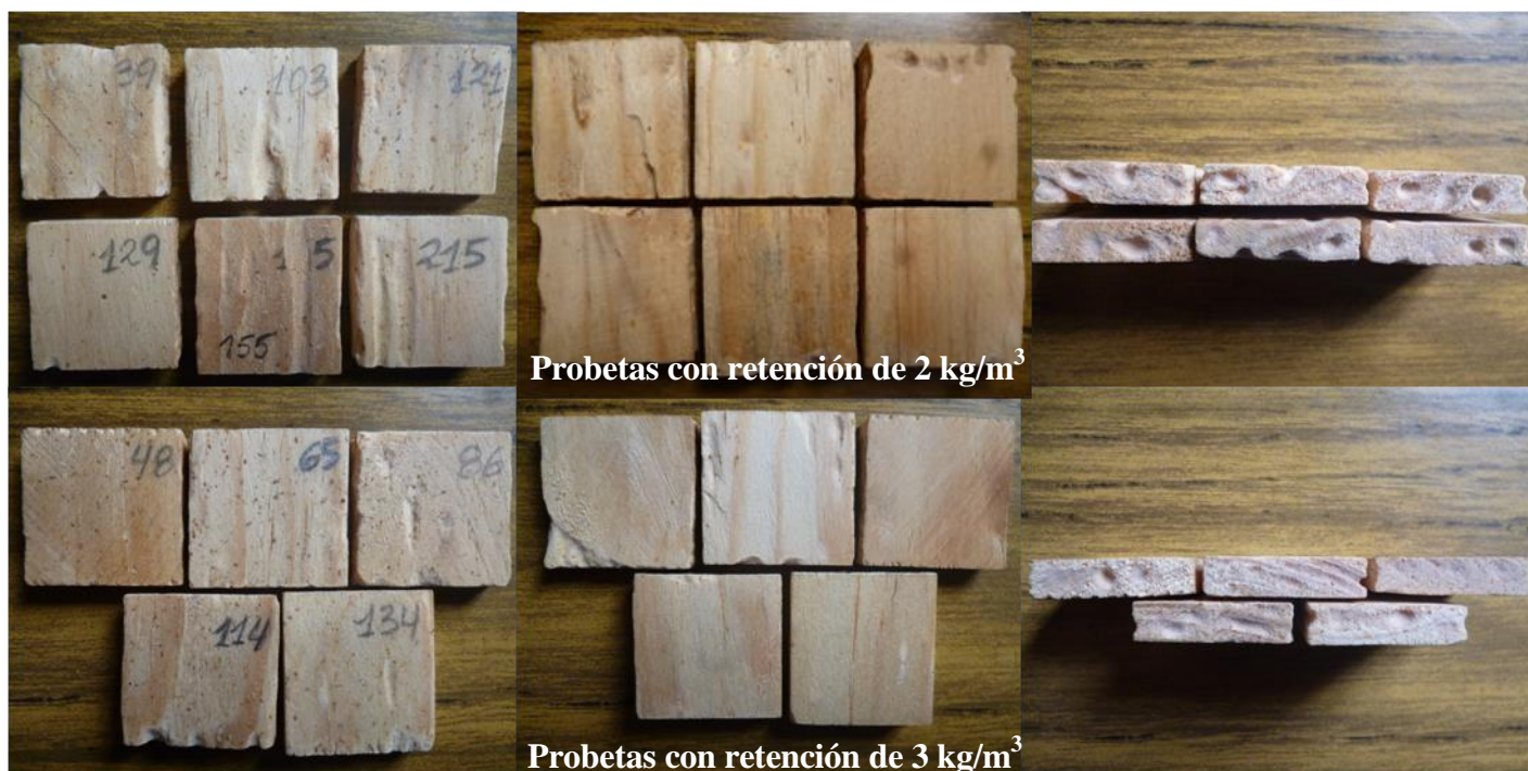
Figura 16: Daño ocasionado en probetas de albura de P. oocarpa con 2 y 3 kg/m 3 de retención de Octoborato de sodio.
