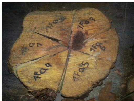
Figura 21: Secciones en las que fue dividido el disco 1Fa.
