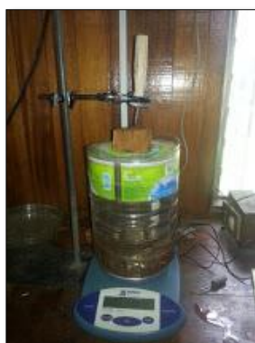
Figura 23: Obtención de pesos para determinar el volumen de cada sección de madera.
