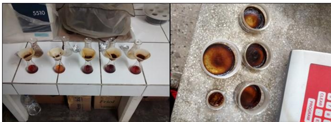
Figura 18: Filtrado en matraces de los extractos hidroetanólicos y residuo luego de secado de la alícuota en la estufa de una repetición.
