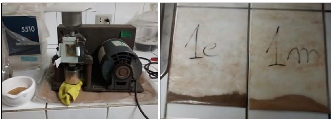
Figura 16: Molino de martillo Thomas y bolsas con las muestras de epicarpio y mesocarpio del árbol 1.
