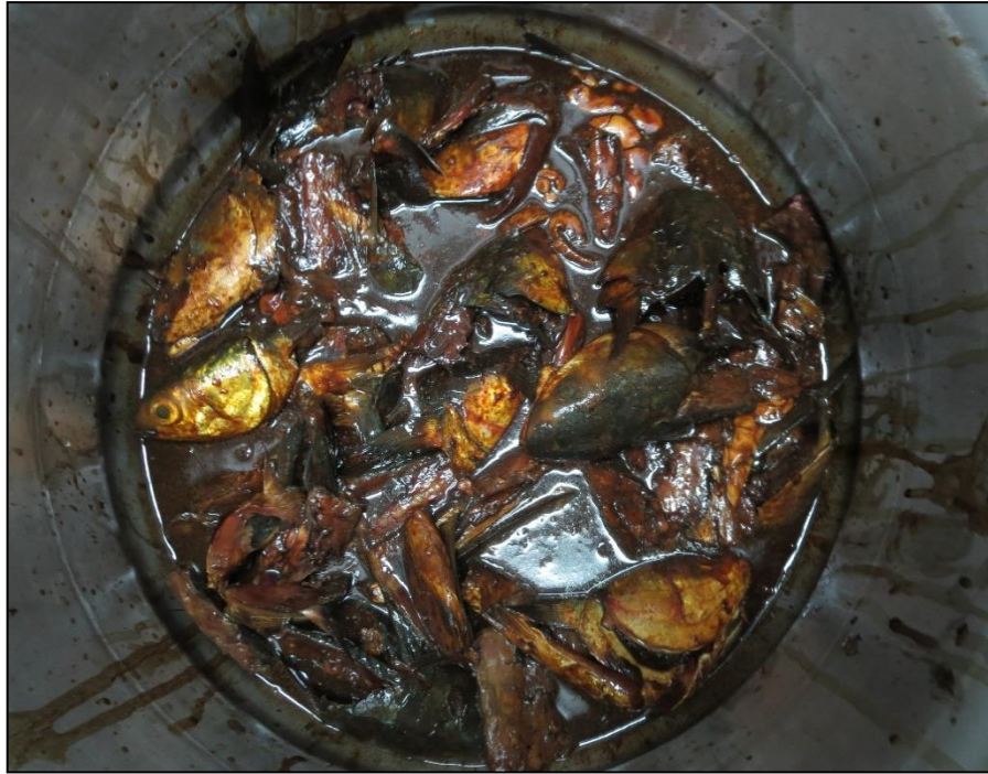
Fotografía 5. Mezcla de los residuos del fileteado de lisa, melaza y B-Lac en el bioreactor de 40 L
