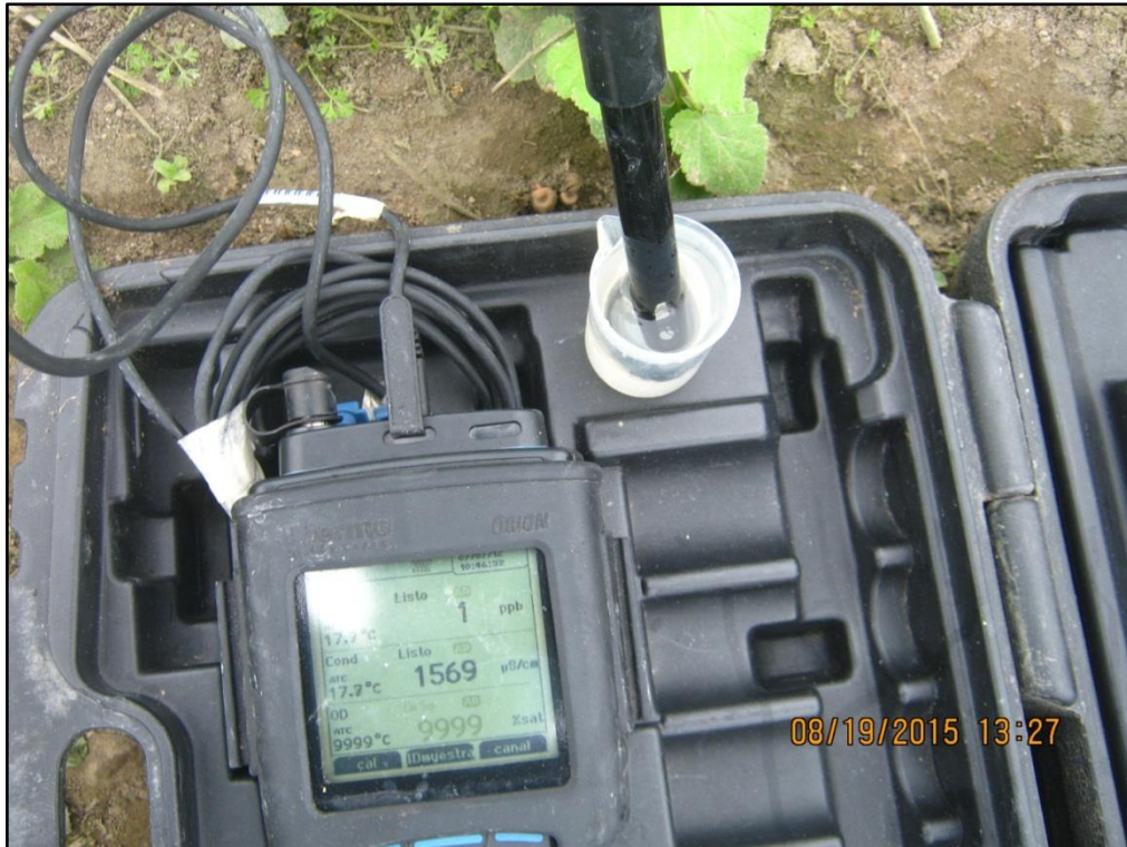
Figura 18: Medición de la conductividad eléctrica de agua de niebla en probeta, en la Asociación Agroindustrial «Llanavilla» (P7), en la zona de estudio
