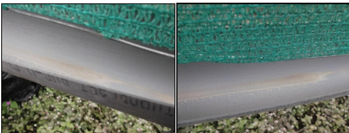
Figura 56: Atrapanieblas instalado en la Asociación Agroindustrial «Llanavilla» – ASALL, al mes de octubre, con rastro de deposición de cemento sobre la canaleta de captación de agua
