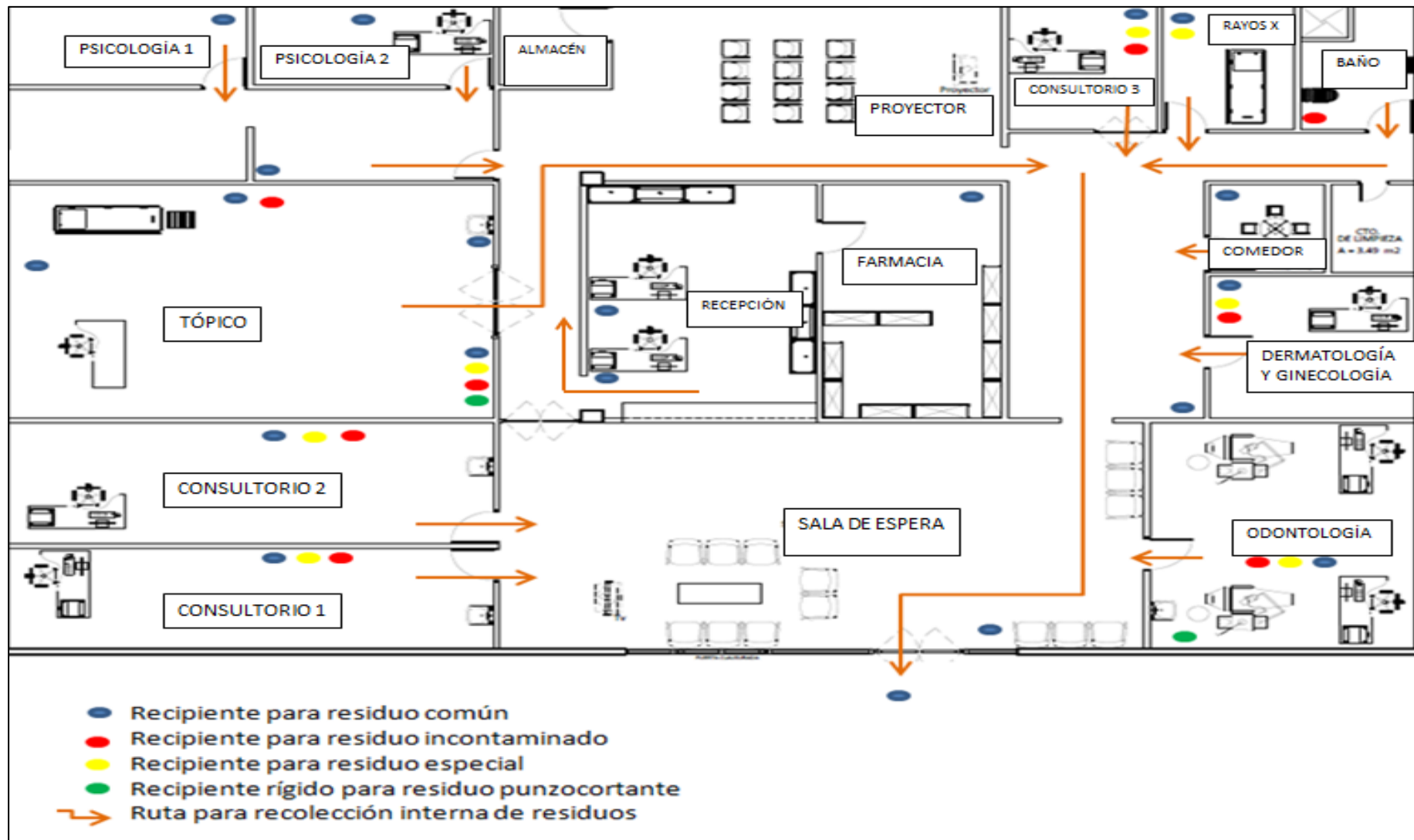
Figura 37: Ruta propuesta de transporte interno de residuos sólidos en la unidad de servicios médicos
