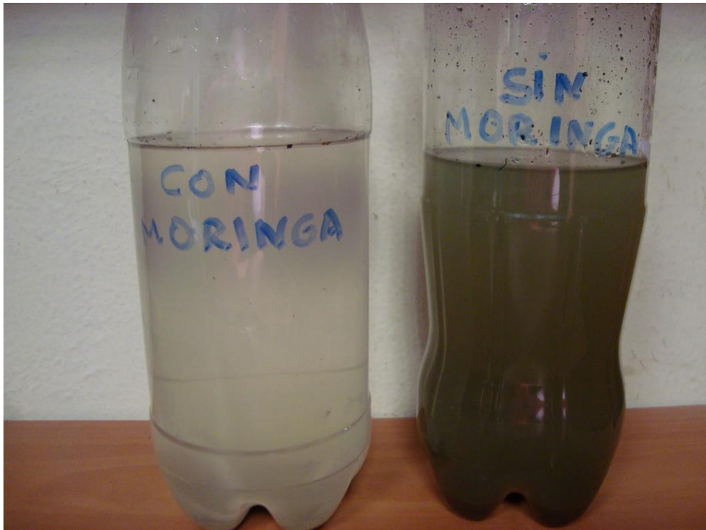
Figura 3: Uso de semilla molida como aclarante. (Botella de la derecha agua con turbidez, a la izquierda agua luego de la aplicación de semillas de moringa).
