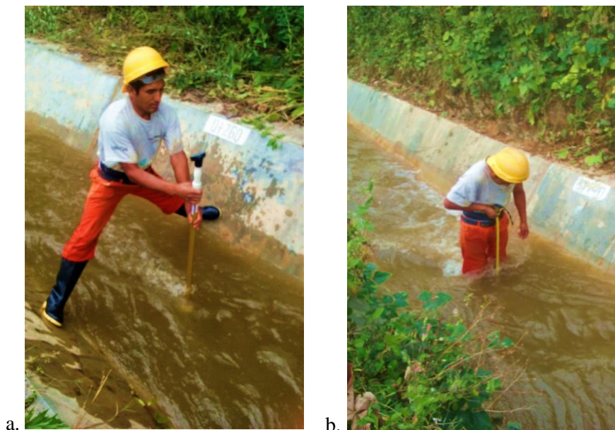
Figura 14: Uso del correntómetro en la sección de control (Tipo I) para determinar la velocidad del flujo (a) y medida de altura de lámina de agua correspondiente (b)
