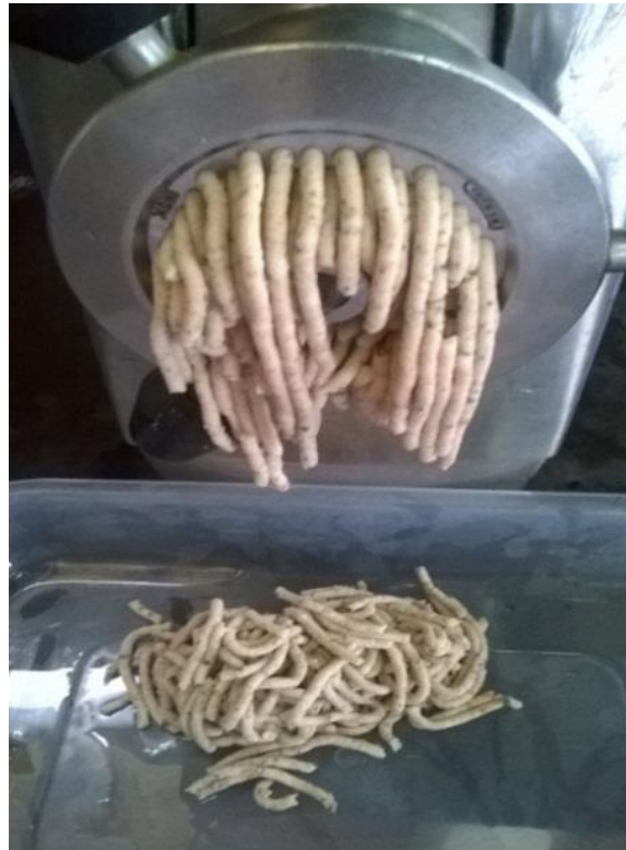
Figura 16. Molienda de residuos cocidos
