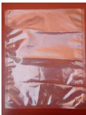
**Figura N° 24. Bolsa de material de coextrusión PE- PA.**
