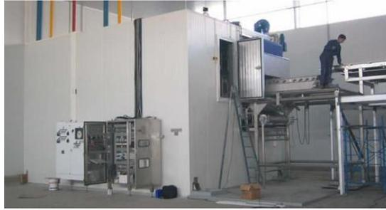
**Figura N° 22. Túnel de congelamiento IQF**
