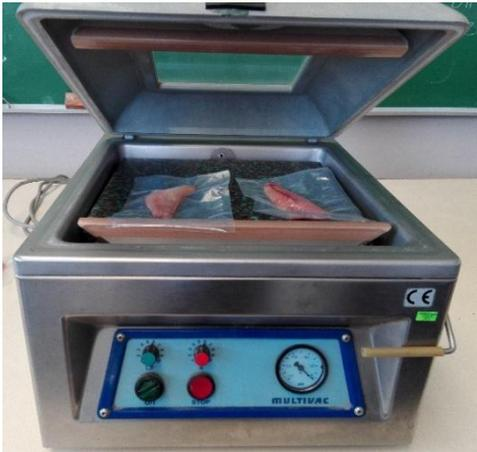
**Figura N° 18. Equipo de envasado al vacío**
