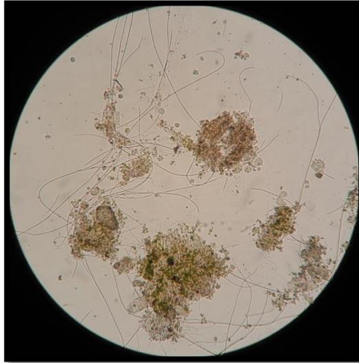
**Figura 11: Presencia de bacterias filamentosas causantes del *bulking* filamentoso en los tanques con TBF.**
