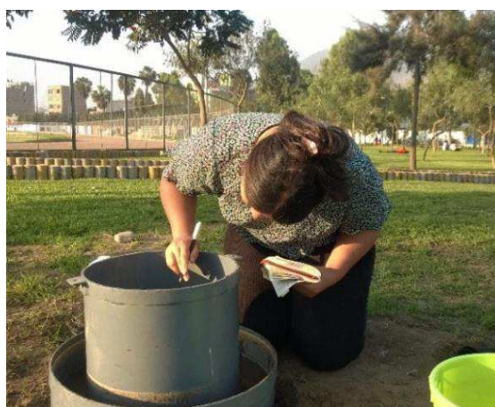
Figura 29: Prueba de infiltración
