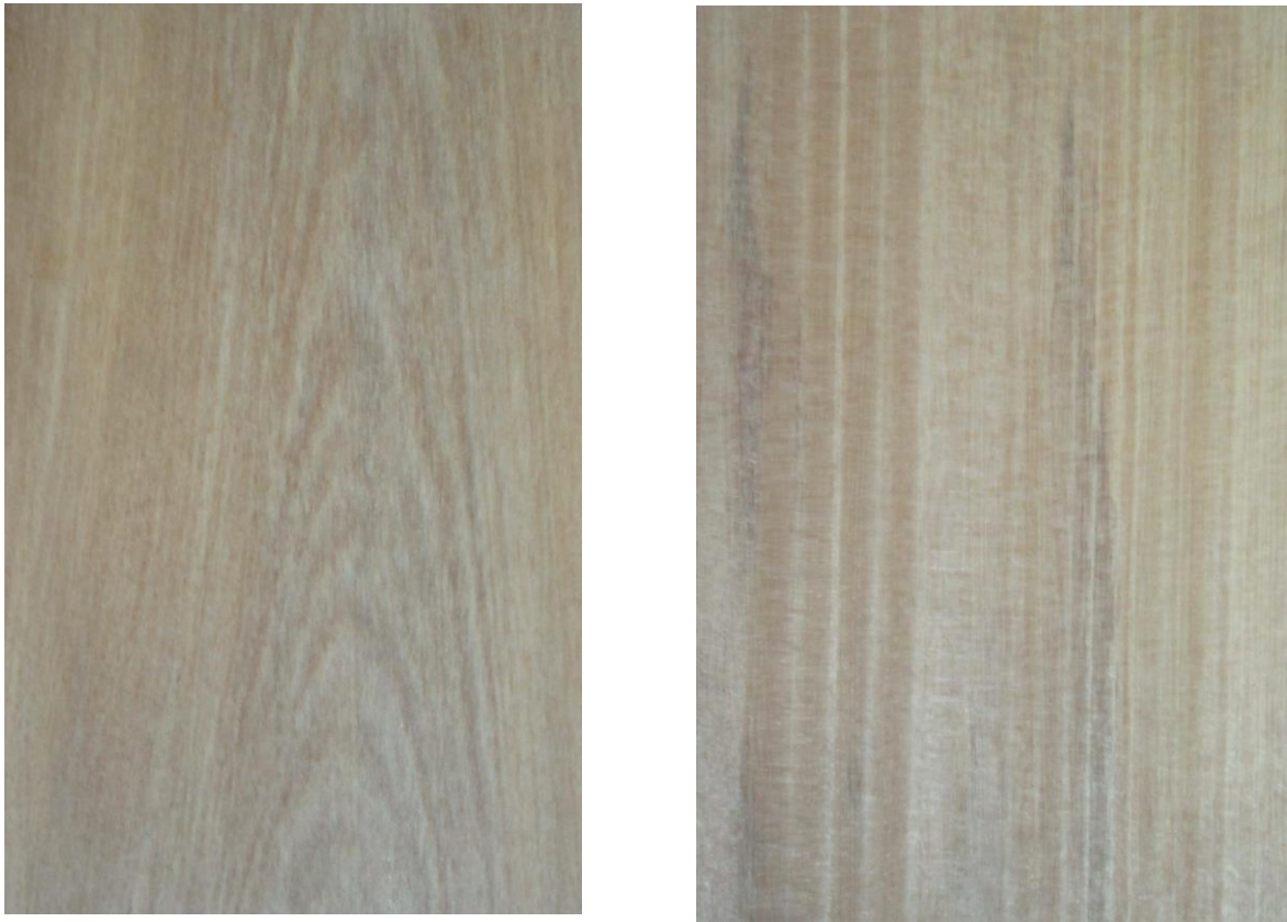
Figura 4: Madera en corte tangencial y radial
