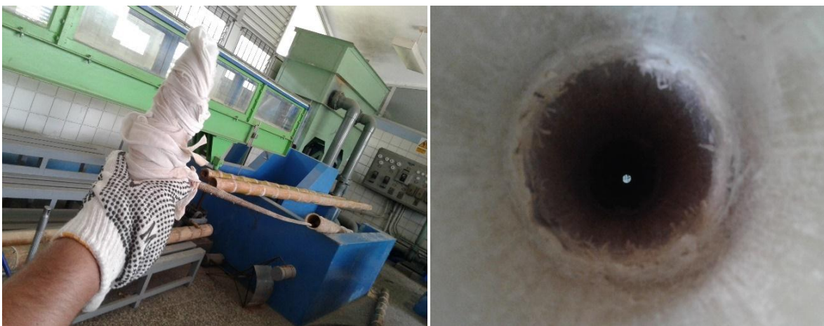
Figura 3.8: Perforación del bambú.
