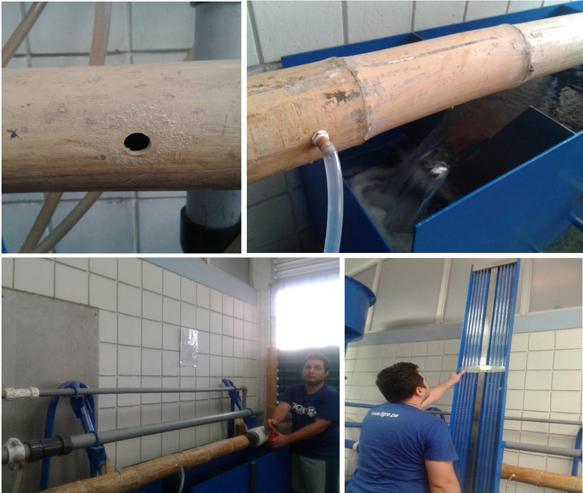
Figura 3.4: Instalación de los piezómetros.
