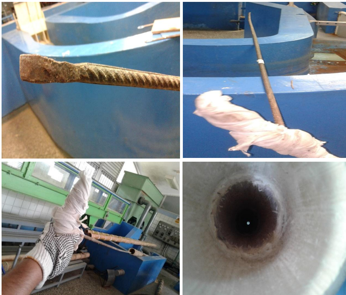
Figura 3.2: Perforación de los entrenudos.
