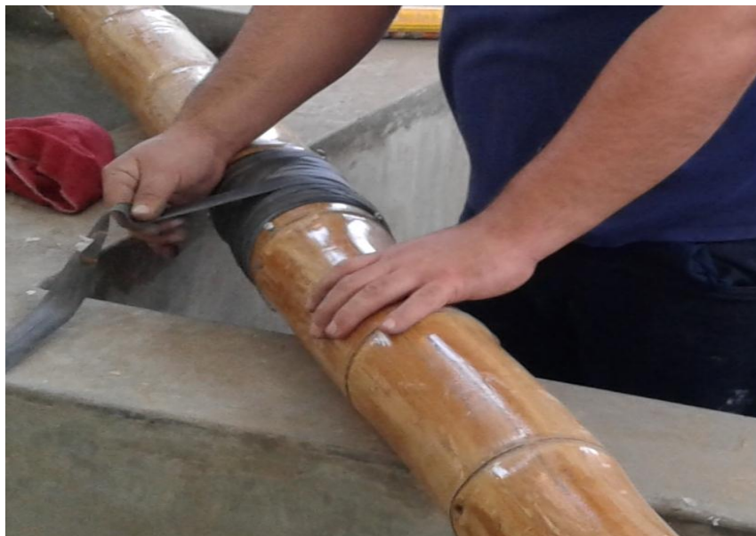
Figura 3.14: Recubrimiento en las uniones de bambú.
