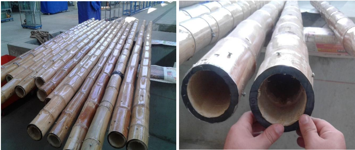
Figura 3.10: Selección y lijado de los tramos de bambú.
