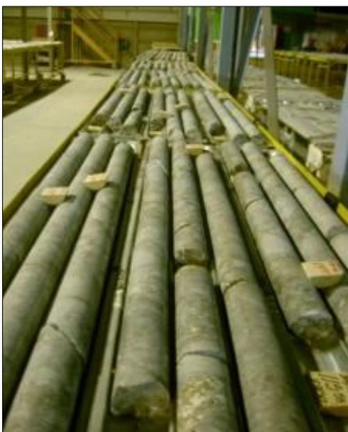
**Figura 5: Fotografía de un testigo de exploración minera**
