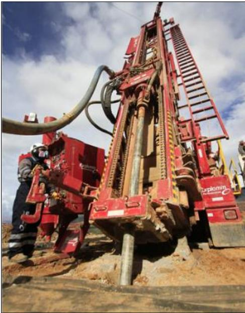
**Figura 4: Equipo de perforación con aire reverso**
