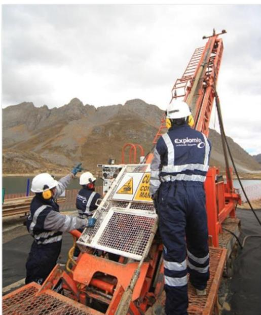
**Figura 3: Equipo de perforación diamantina**
