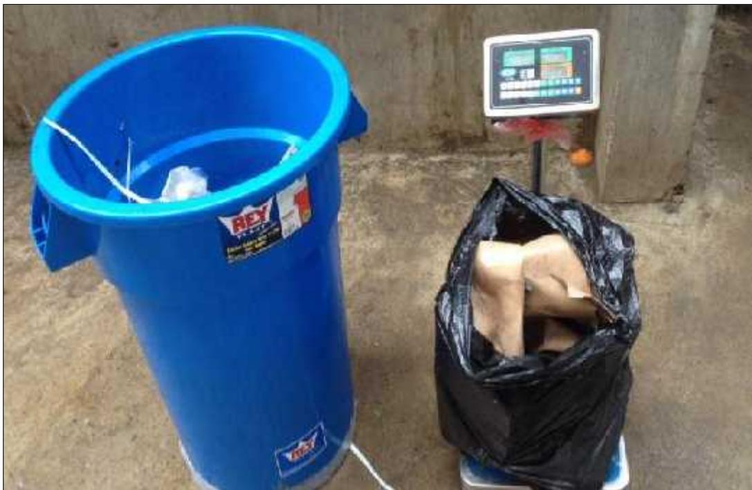
**FOTO 4: Cilindro y balanza utilizados para la caracterización de residuos**
