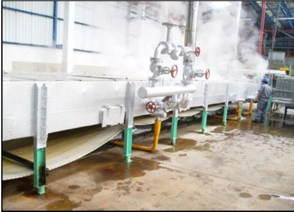
Figura 6: Anchovetas envasadas puestas en el cocinador continuo.
