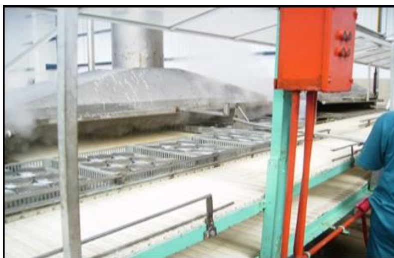
Figura 5: Deshidratación de la carne de anchoveta envasada. Fuente: Planta Samanco - Pesquera Diamante (2010).
