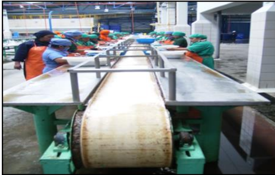
Figura 3: Corte y eviscerado de anchovetas para conservas.
