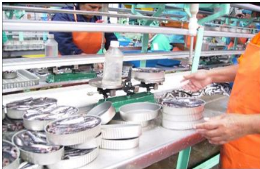
Figura 4: Envasado de anchovetas para conservas. Fuente: Planta Samanco - Pesquera Diamante (2010).
