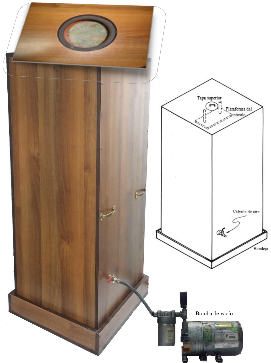
Figura 4: Torre de sedimentación. Adaptado de torre de sedimentación que opera al vacío para la inoculación de hongos de mildiu polvoriento. (Reifshneider, F; Boiteux, L. 1988)
