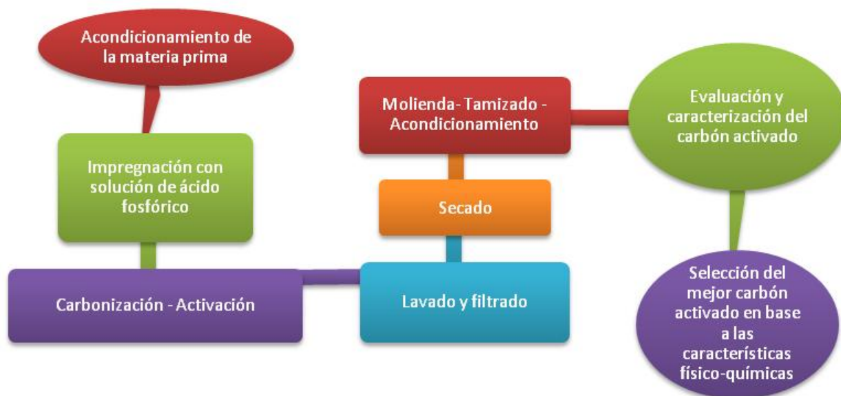
Figura 14: Diagrama de la metodología aplicada para la obtención de carbón activado y sus evaluaciones
