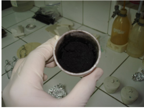
Figura 19: Carbonización - Activación del carbón activado en polvo.
