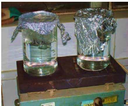
Figura 21: Calentar agua destilada a 95°C.
