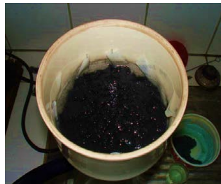
Figura 22: Echar agua destilada caliente al carbón activado para lavar.
