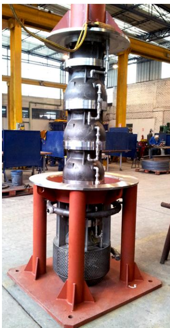
Figura 17. Cuerpo y soporte de las bombas del sistema de conducción
