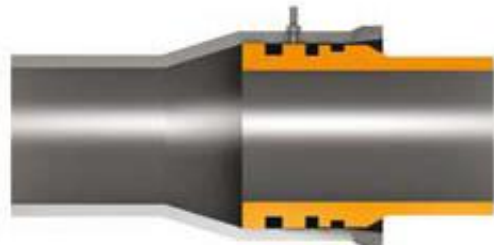
Figura 4. Conexión entre tuberías de PRFV
