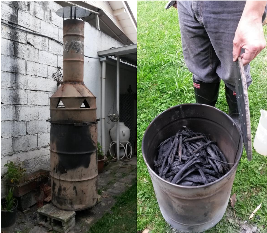
Figura 6: Horno de pirólisis y biochar producido
