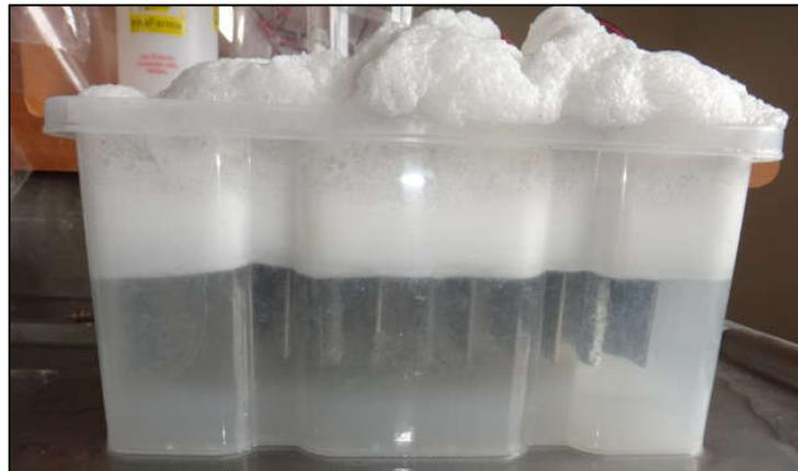
Figura 47. Proceso de electrocoagulación de la muestra mezcla 1:6.
