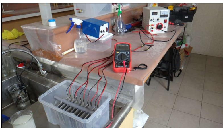
Figura 9. Sistema de electrocoagulación para los ensayos preliminares.
