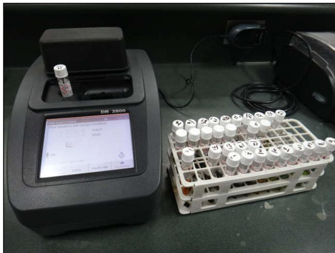
Figura 41. Equipo de espectrofotómetro HACH para determinar la DQO.
