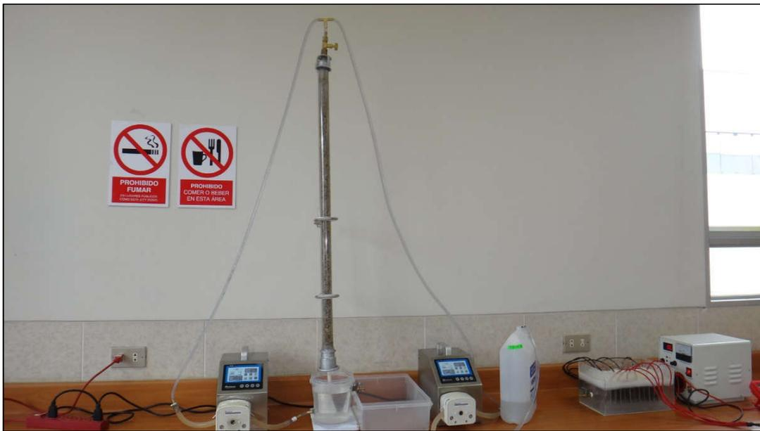
Figura 12. Sistema de tratamiento combinado electrocoagulación-filtro biológico.
