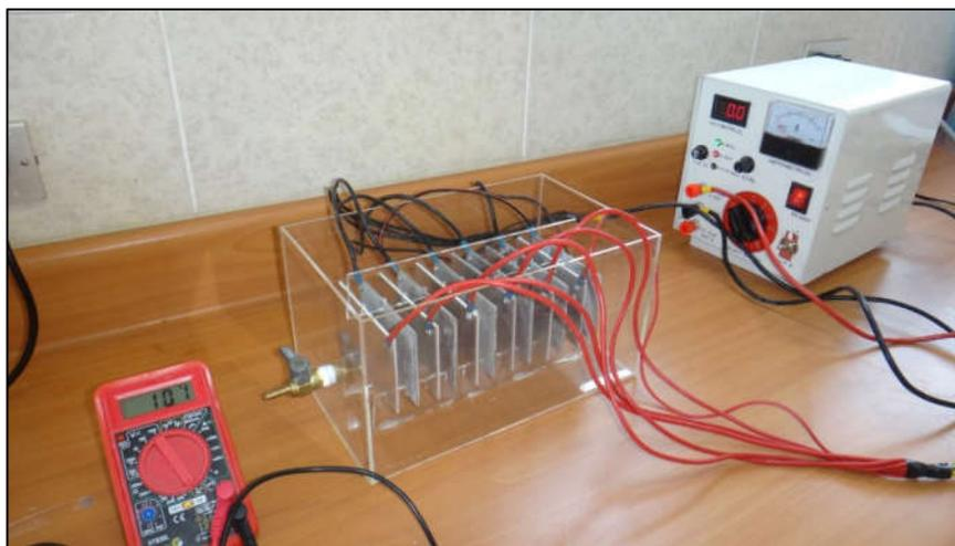
Figura 10. Reactor de electrocoagulación conectada a la fuente de corriente.
