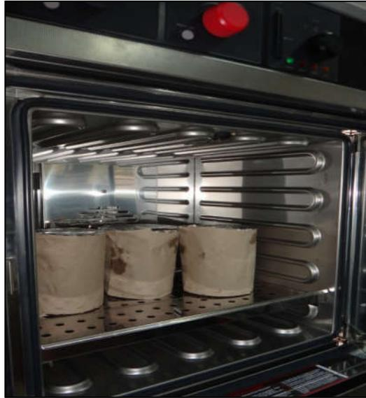
Figura 46. Incubación del medio soporte del biofiltro.
