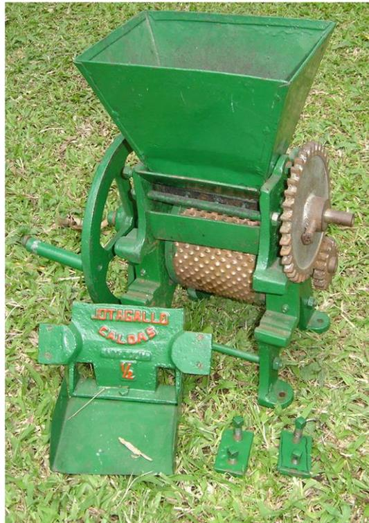
**Figura 7. Despulpadora de tambor horizontal.**
