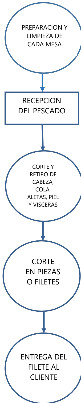
Figura 6: Diagrama de flujo del fileteo del pescado
