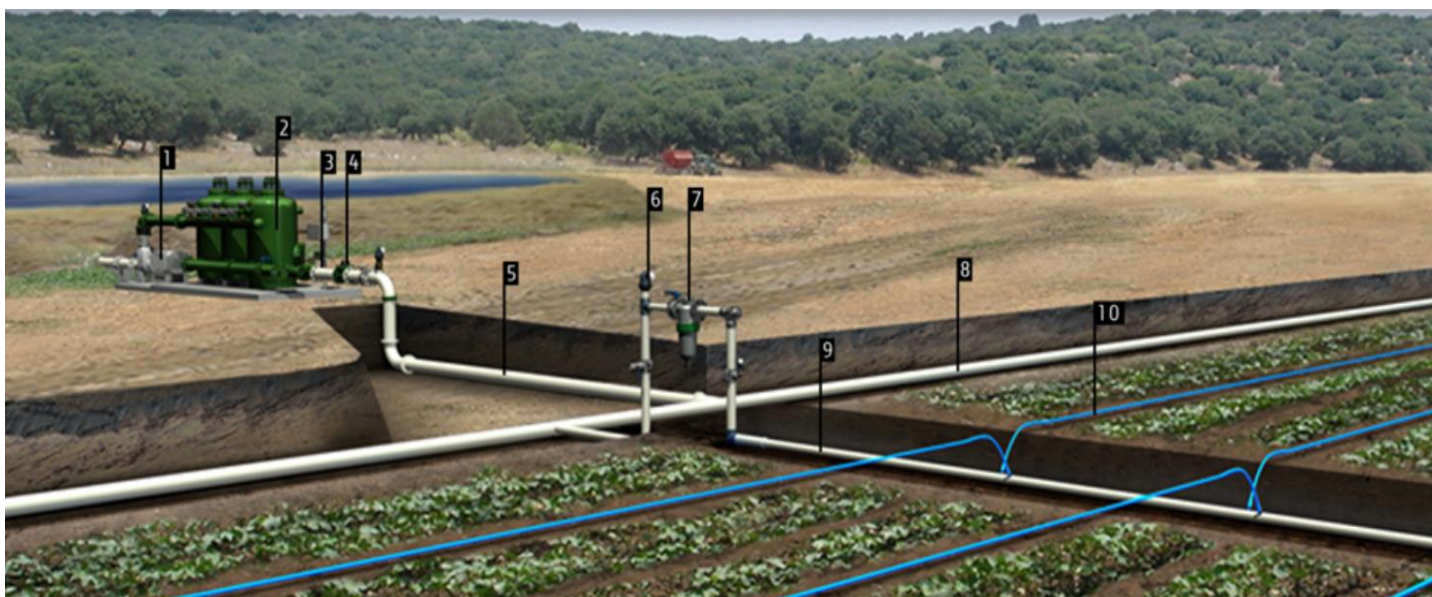
Imagen 1: Componentes de un sistema de riego por goteo (Fuente: Catalogo JDW 2012)
