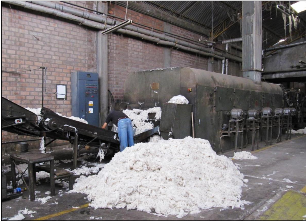
Figura 15: Operario realizando desmanche a la salida del secado.
