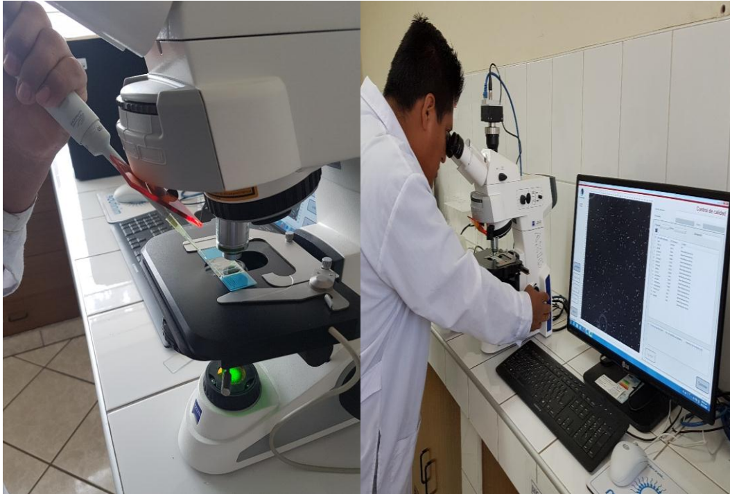
Figura 6. Utilización de la cámara desechable de análisis de conteo y motilidad (Leja®) para evaluación de las muestras con el sistema CASA.
