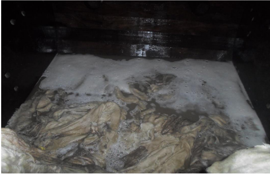
Figura 9: Pieles saladas con productos de pre-remojo en rotación dentro del botal
