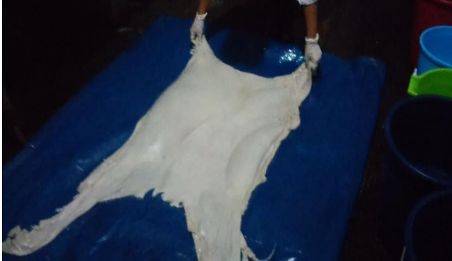
Figura 13: Piel al final del proceso de purga
