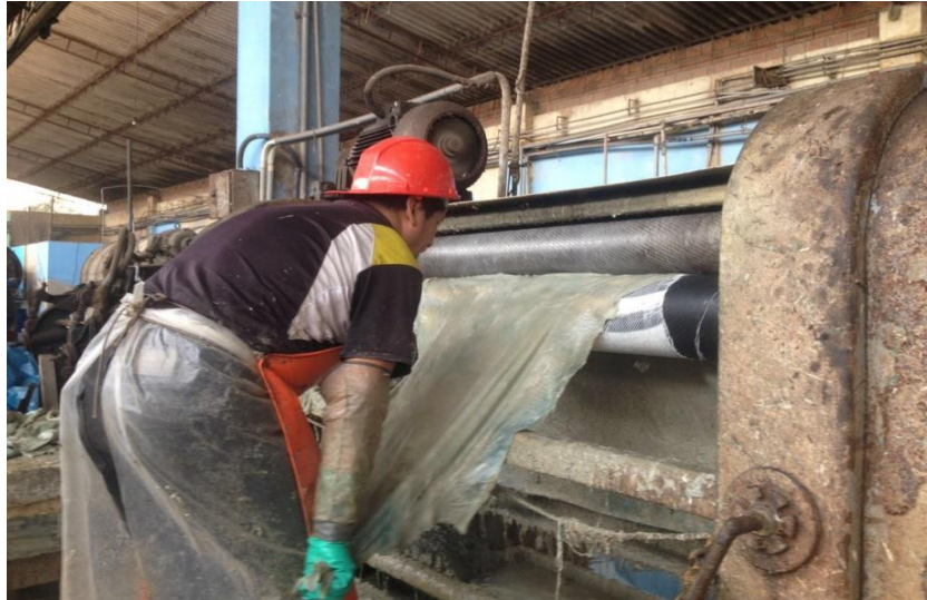
Figura 12: Pielas peladas durante el descarnado
