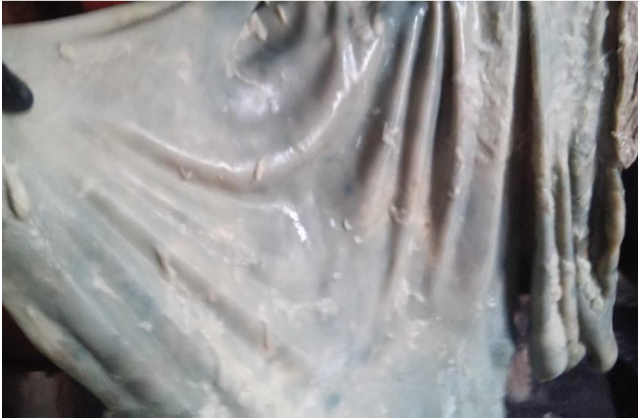
Figura 11: Pieles totalmente depiladas y ligeramente hinchadas obtenidas al final del proceso de pelambre
