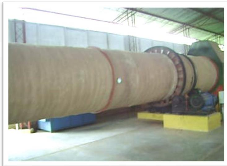
**Figura 4: Horno de Secado.**
