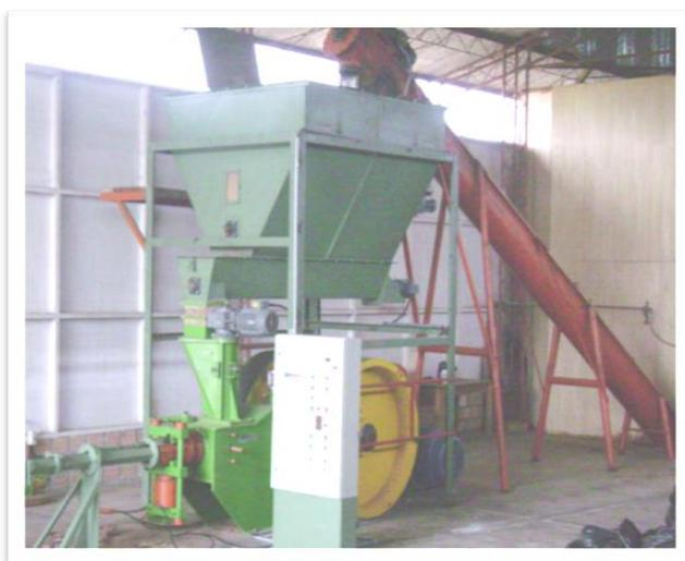
**Figura 5: Planta briqueteadora para residuos de madera**
