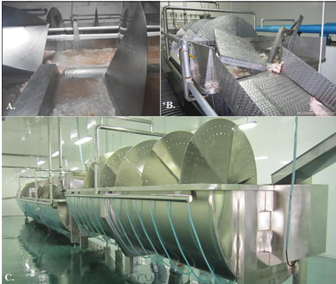
Figura 12. Proceso de Enfriado - Chiller
