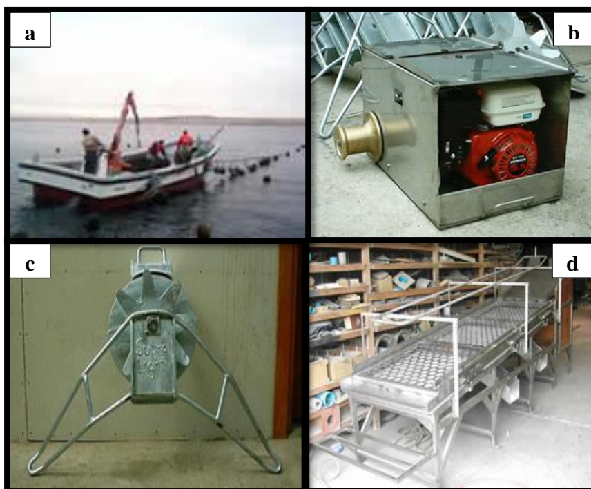
Figura 4: Equipos empleados en el cultivo suspendido de concha de abanico. Embarcación y grúa mecánica (a), huienche (b), rolete (c) y maquina tamizadora (d) (Bermudez et al., 2004).
