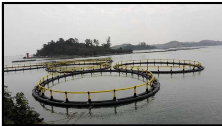
Figura 10: Jaula de peces circular de tubería de polietileno de alta densidad (HDPE) (Fuente: López y Ruíz 2015).
