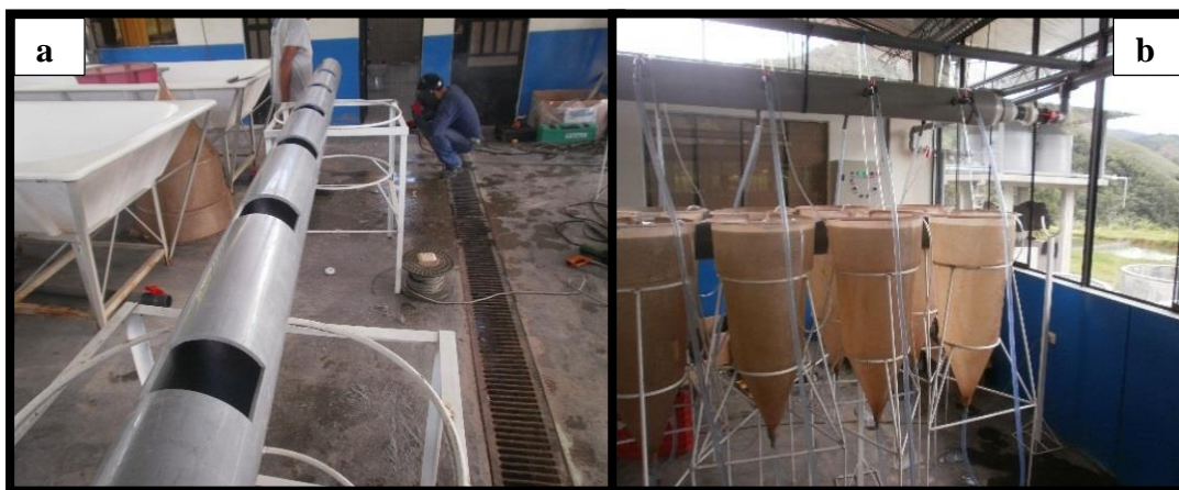
Figura 62: Tubería con reducción para atenuar flujo de agua (a) y sistema de incubación (b) en el fundo Palmeiras. (Fuente: Spena Group S.A, división de acuicultura).
