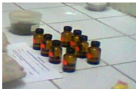
d) Preparacion de la muestra para analisada por HPLC/FLD
