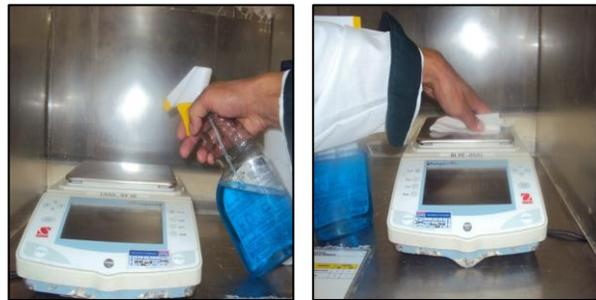
**Figura 1.** Limpieza y secado de balanza.
