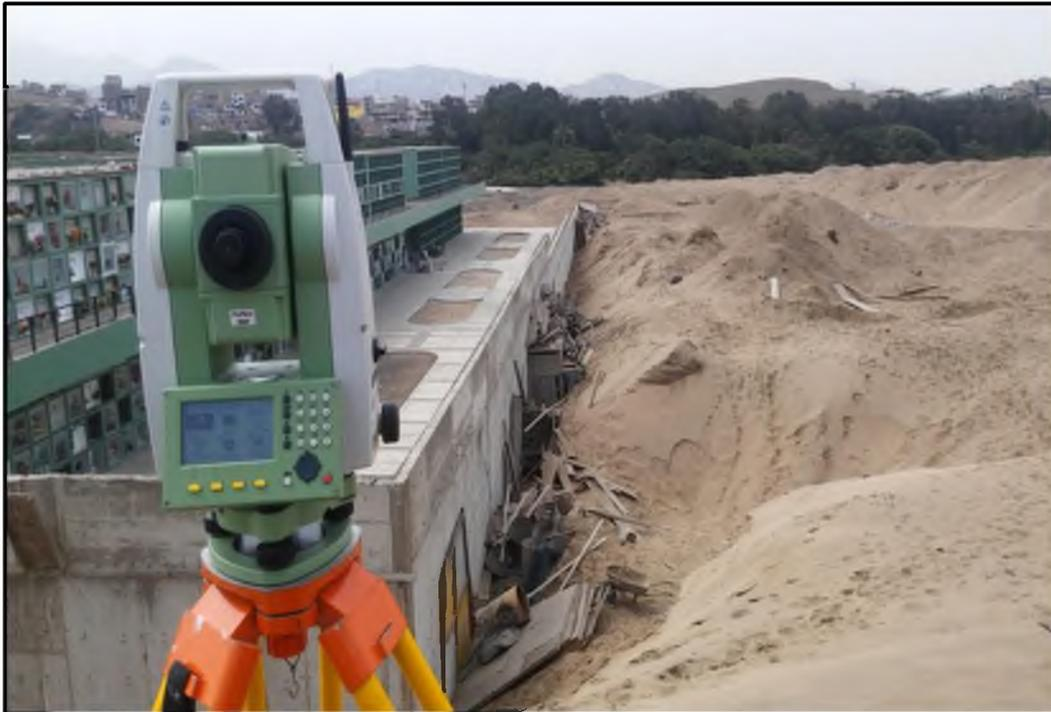
**Foto N°09:** En la imagen se muestra la Estación Total Leica TS02, con precisión 01".
