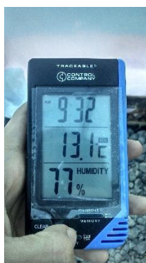
Figura 14: Medición de temperatura y humedad relativa con termohigrómetro
