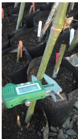
Figura 13: Medición de diámetro de estacas con vernier
