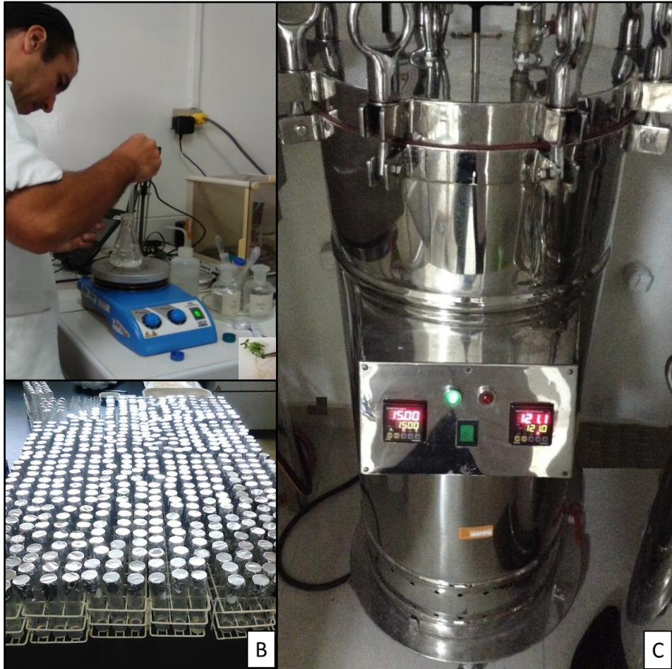
Preparación de medios: (A) Calibración del pH a 5.7; (B) Medios de cultivo dispensados en tubos de ensayos, rotulados y sellados para autoclavar; (C) Autoclave de esterilización para los medios de cultivo.
