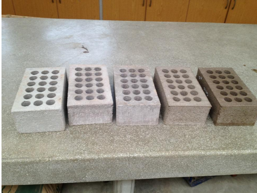
Ladrillos de 18 huecos fabricados con residuos de demolición
