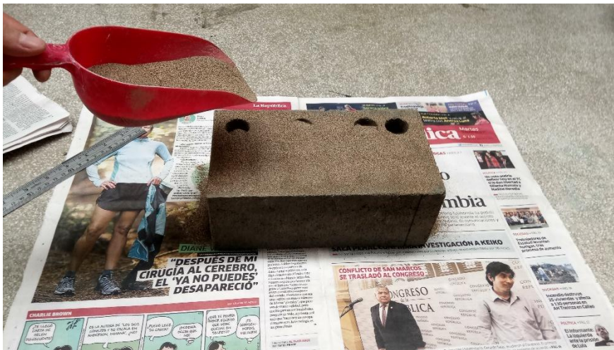
Ensayo de porcentaje de vacíos: Llenado de los orificios del ladrillo
