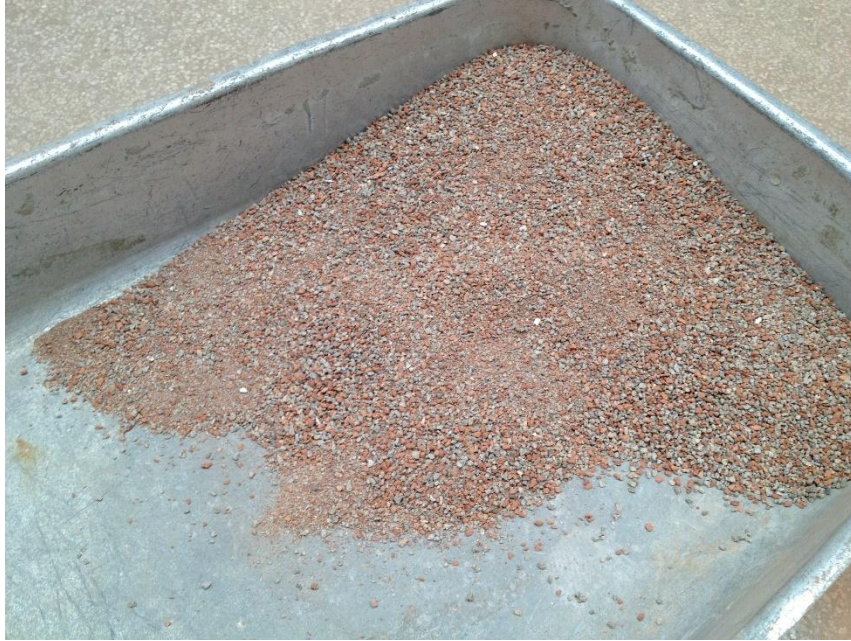
Agregado reciclado. Contiene partículas que pasan el tamiz N°8 pero se retienen en el tamiz N°100
