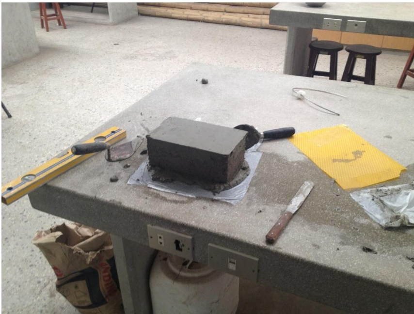
Colocación del capping en los ladrillos para ser llevados al ensayo de resistencia a la compresión
