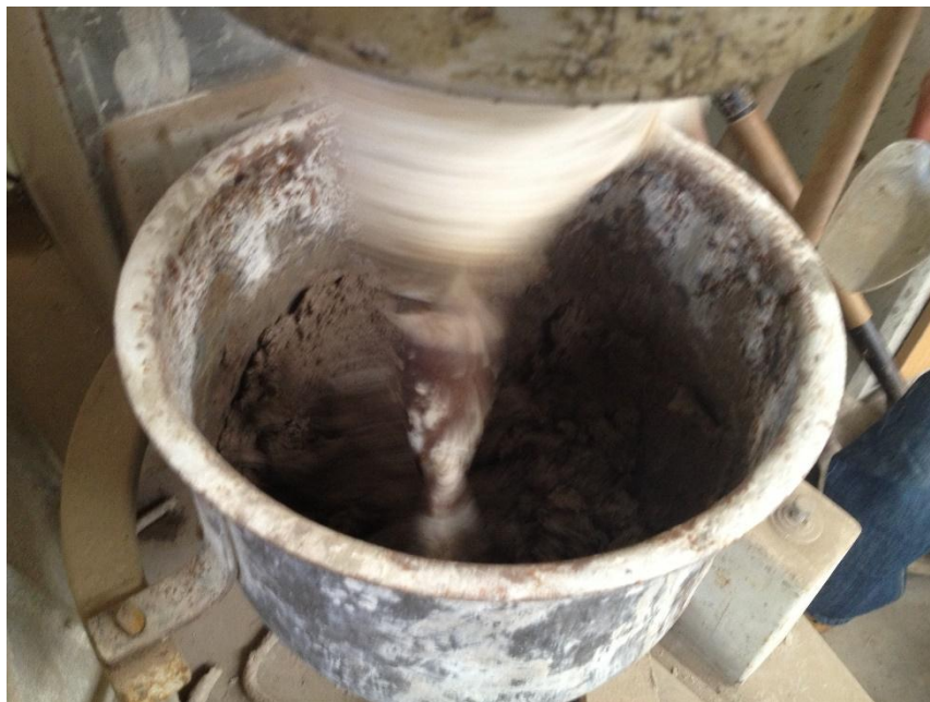
Preparación de la mezcla para la fabricación del ladrillo
