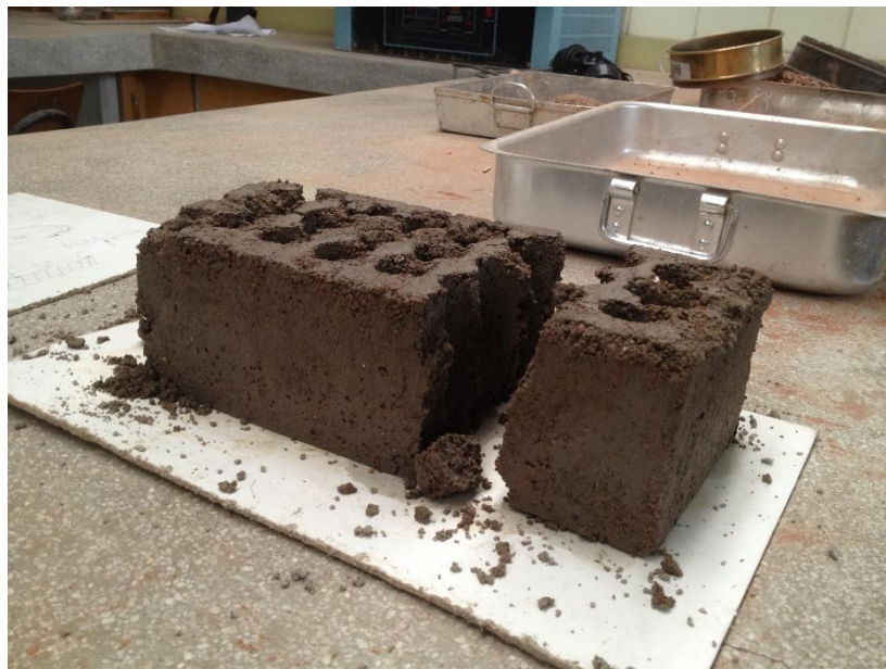
Figura 8: Rotura y desmoronamiento por falta de agua en la mezcla
