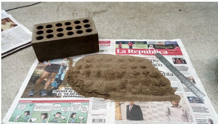
Ensayo de porcentaje de vacíos: Arena total contenida en los orificios del ladrillo
