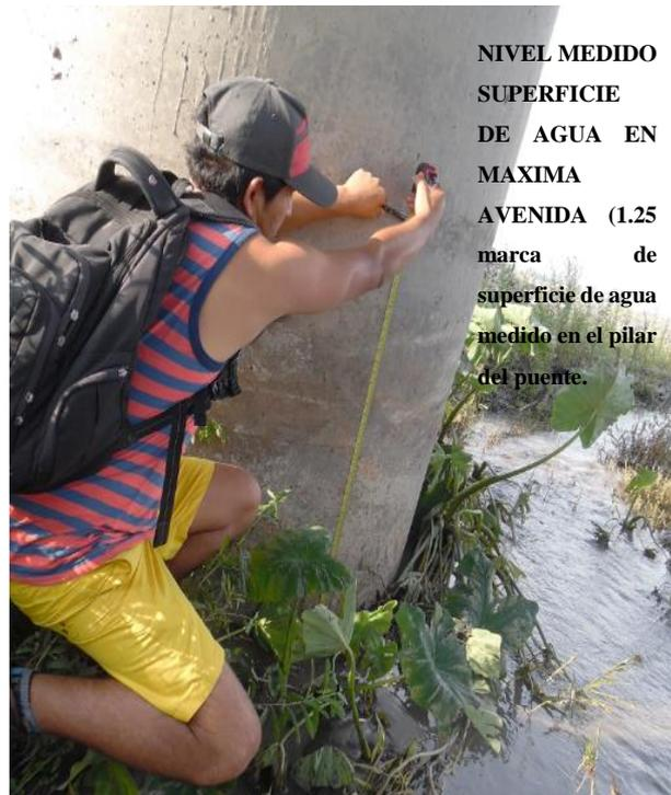
**Figura 42. Nivel de superficie medido, usado para la calibración del modelo.**
