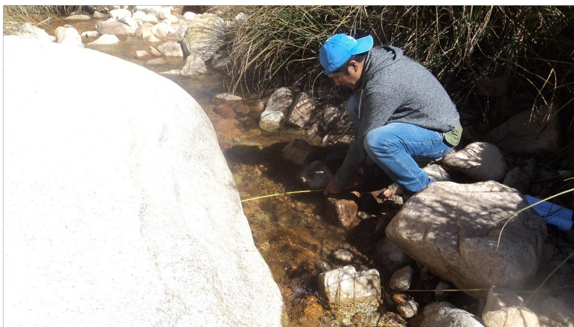
Figura 5.7: Aforo por el método del flotador.
