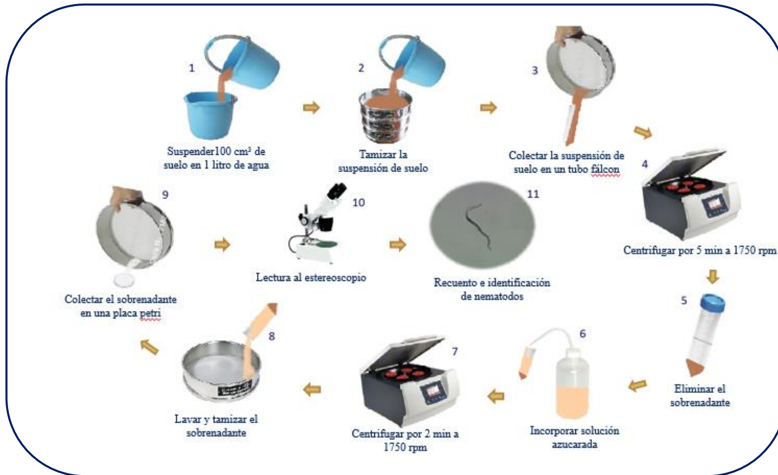
Figura N°3. Extracción de individuos de suelo, método de centrifugación (Jenkins, 1964)
