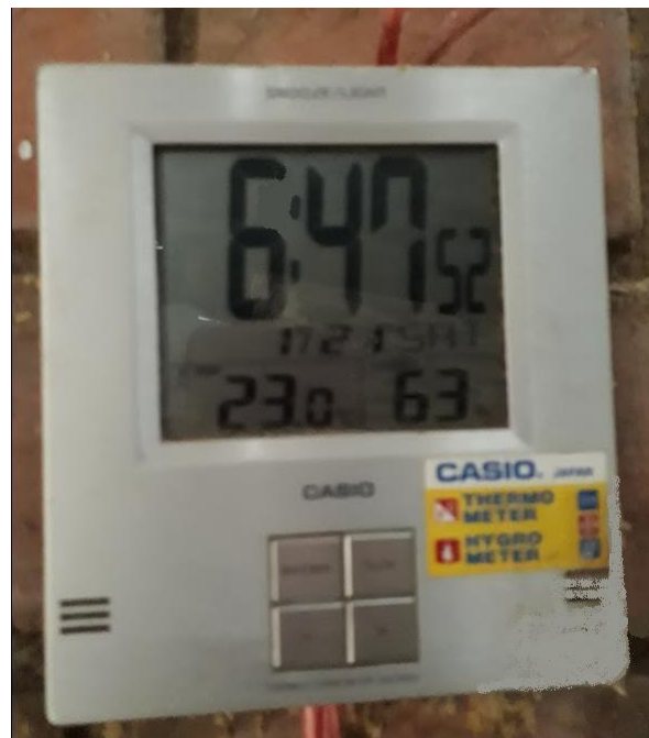
Foto 7: Medición del Temperatura (C°) y Humedad relativa (%HR) en almacén durante la Investigación
