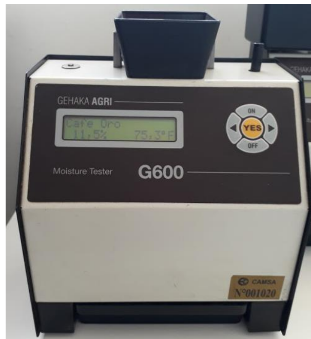
Foto 4: Medición de la Humedad del grano de café con el Hidrómetro Gehaka Agri G 600
