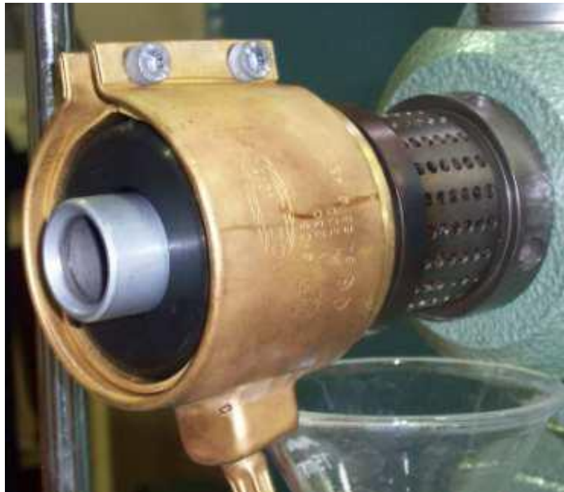
Figura 8: Dispositivo para el calentamiento de la cabeza de la cámara de prensado.
