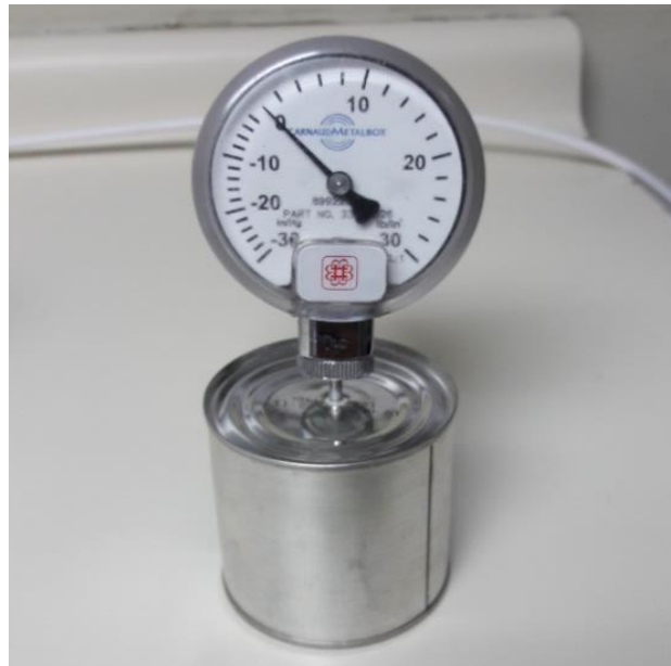
Figura 16: Evaluación de presión de vacío - Vacuómetro Bourdon.
