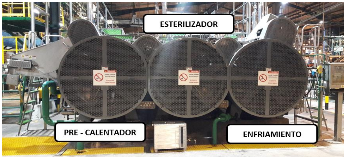
Figura 18: Esterilizador rotatorio continuo de tres cuerpos.
